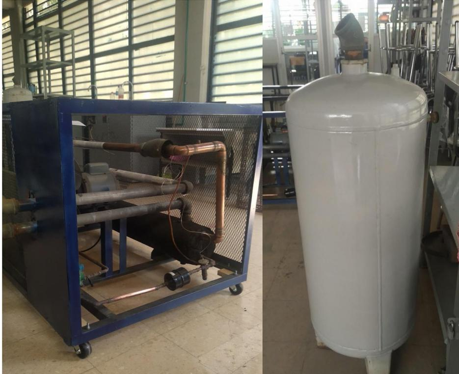
**Figura 4.13** Acabado final de la estructura metálica y el tanque de recirculación.
