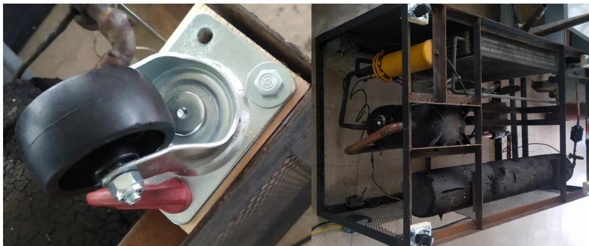
*Figura 4.6 Instalación de ruedas a la estructura*
