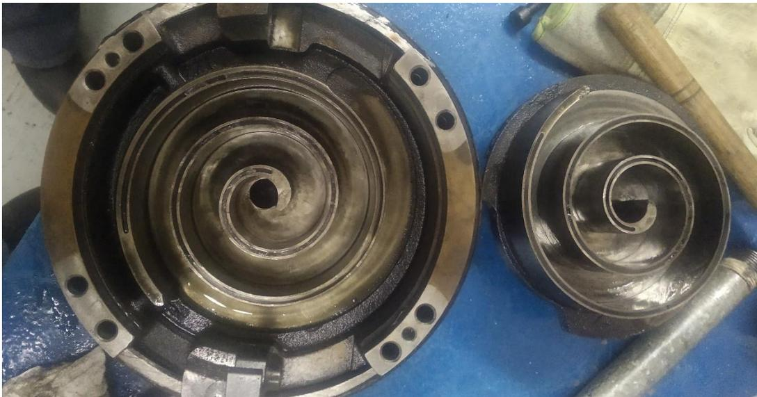
**Figura 4.8** *Espirales del compresor tipo Scroll*
