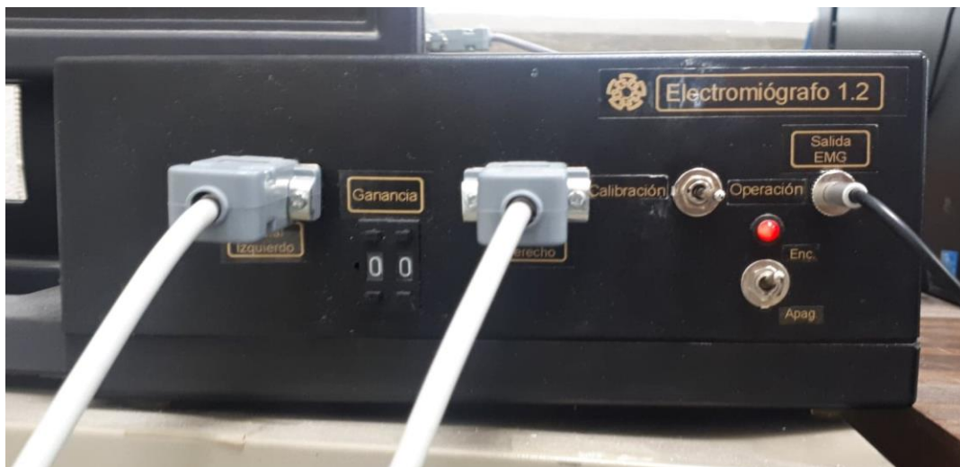
Figura 16 Electromiógrafo digital UNAM-CINVESTAV del Laboratorio de Fisiología de la DEPeI de la Facultad de Odontología.
