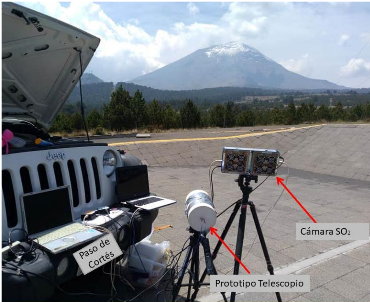
Figura 7. Mediciones del volcán Popocatepetl desde Paso de Cortés con la cámara SO 2 (lado derecho) y prototipo del instrumento óptico de medición descrito en la presente tesis (lado izquierdo).
