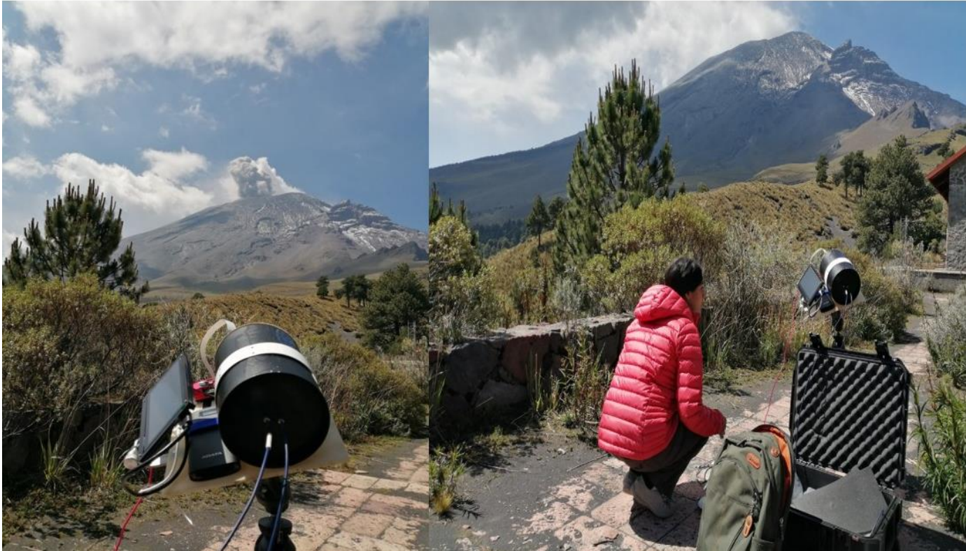
Figura 29. Primeras mediciones efectivas con el instrumento óptico en el volcán Popocatepetl realizadas desde el sitio de Tlamacas a una distancia de 4.1 km en línea recta al volcán. Condiciones meteorológicas óptimas para la medición.
