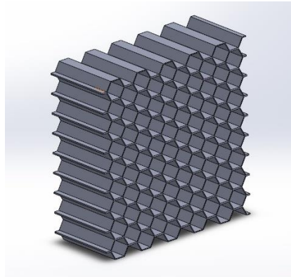
Figura 39 Sección del Honeycomb a utilizar
