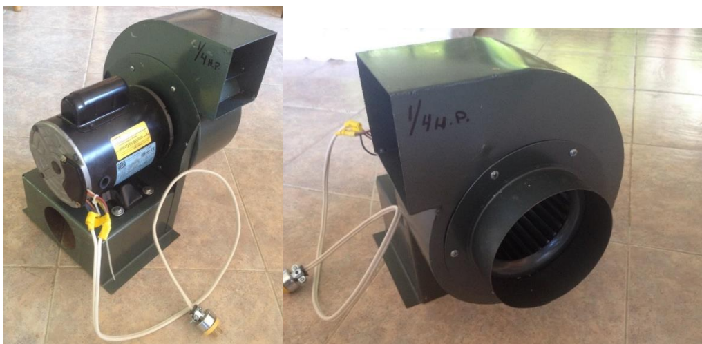
Figura 65. Fotografías de extractor de aire de corriente alterna de 1/4 H.P. para prototipo
