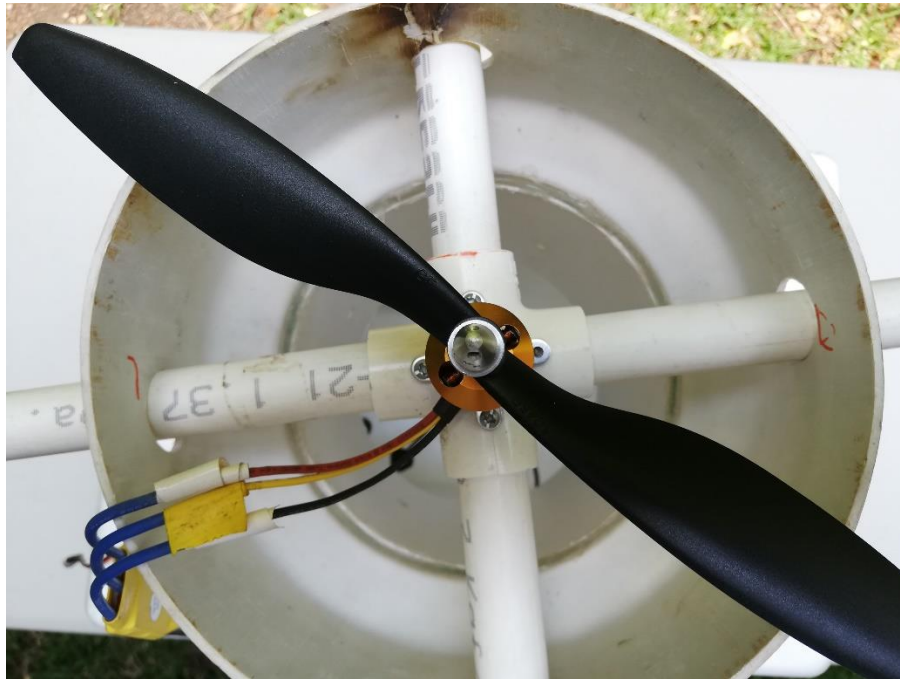
Figura 75. Vista superior del motor del drone anclado a tubería de PVC
