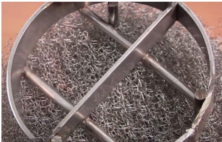
Figura 62. Fotografía de la parte superior del eliminador de neblina de 6 [in] de diámetro
