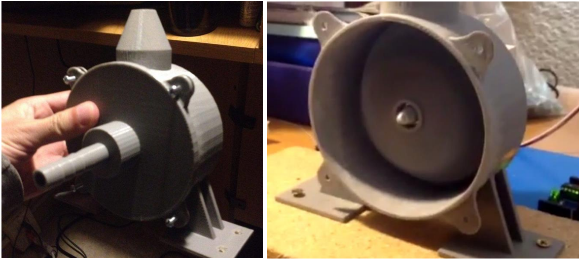
Figura 71. Ensamble preliminar carcasa y tapa izquierda Puesta en marcha y prueba del rotor con Arduino derecha.
