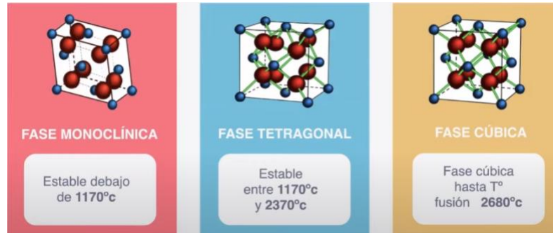
Fig 1. Fases cristalográficas del dióxido de zirconia.
