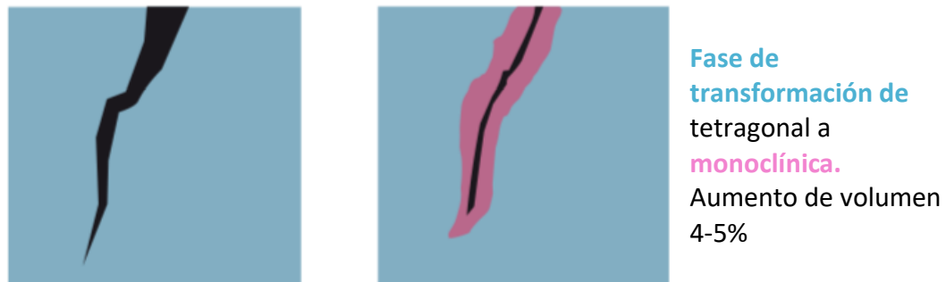
Figura 2. Dibujo esquemático del endurecimiento por transformación (2).
