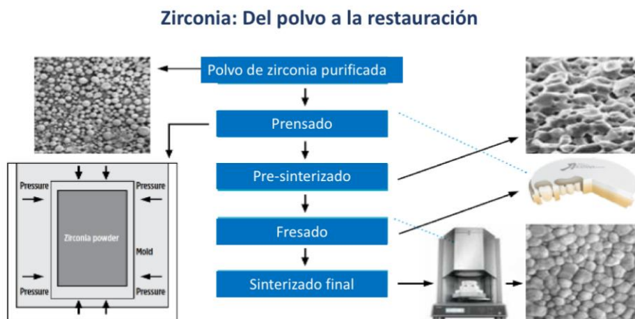
Figura 3. Fabricación a partir del polvo de dióxido de zirconio a la pieza en bruto, fresada y sinterizada por completo (3).
