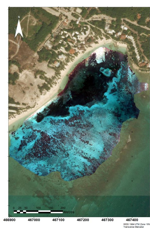
Figura 12. Ortomosaico multiespectral (RGB-NIR) de Akumal, Quintana Roo, con previa corrección atmosférica.
