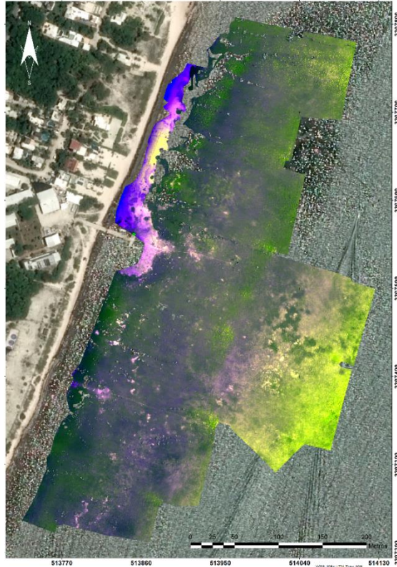
Figura 17. Ortomosaico multiespectral (RGB), con previa corrección atmosférica, deglint y corrección de columna de agua, de Pto. Morelos, Quintana Roo.
