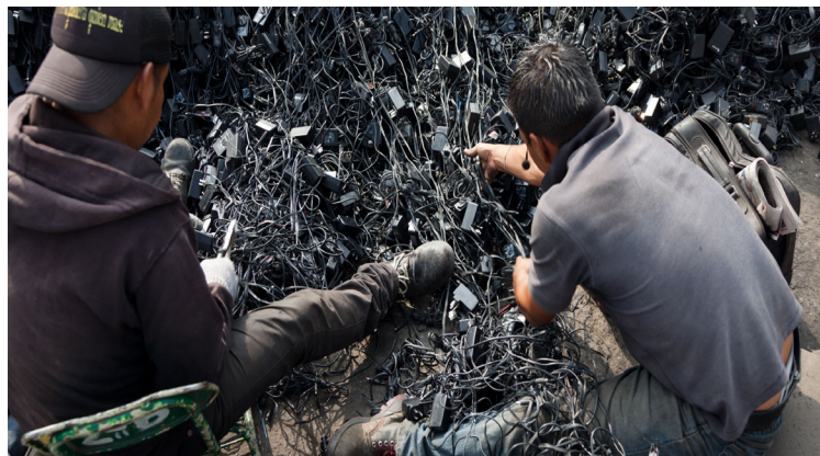
imagen 2 "Recicladores escogen entre extensiones y cables; serán quemados para eliminar el aislamiento y exponer el cobre", "We Found Your Last Smartphone, Next to Your Old VCR", reportaje de Michael Smith e Isabella Cota, con fotografías de Alejandro Cartagena, Bloomberg Businessweek , 11.14.2016
