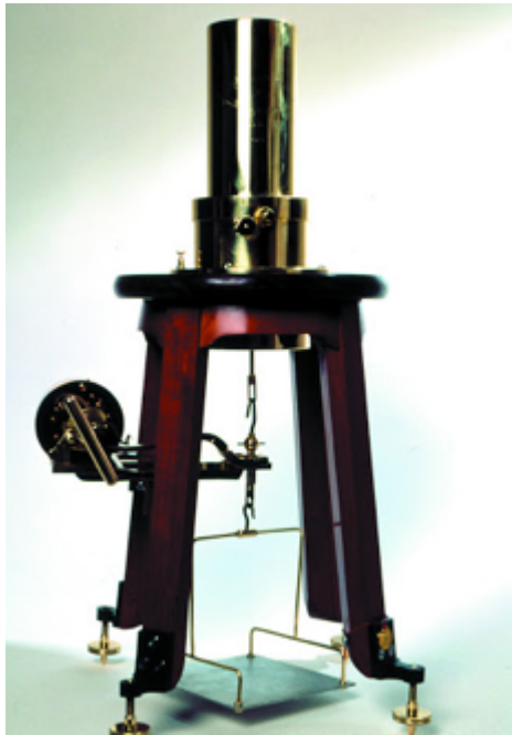
Figura 2 Balanza Piezoeléctrica. Fuente: http://museovirtual.csic.es/csic75/instrumentos/cuarzo_piezoelectrico/cuarzo_piezoelectrico.html
