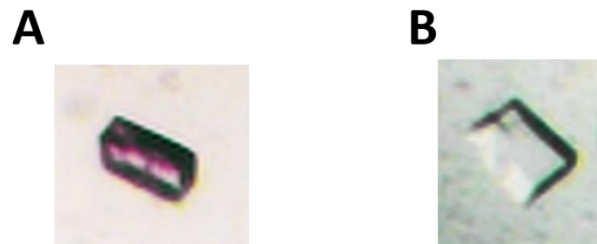
Figura 4.8 Cristales obtenidos con solución amortiguadora de citratos con PEG al 10 % m/v y pH 5.6 Solución amortiguadora de citratos con PEG al 10 % m/v y pH 5.6. A) Cristales rojos correspondientes a GdADH-III B) Cristales incoloros identificados posteriormente como Gd6PGD .
