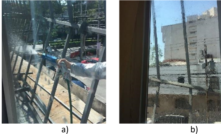
Figura 19. Prueba Tipo 2, a) Vista exterior de la realización de prueba tipo 2, con la varilla calibrada; b) Vista interior de la realización de la prueba, sin infiltraciones de agua.
