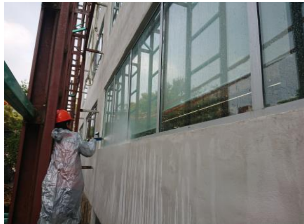
Figura 23. Realización de la prueba tipo 2. Utilización de la boquilla de aspersión, cumplimiento con los requerimientos que pide el estándar AAMA 501.2 -03.
