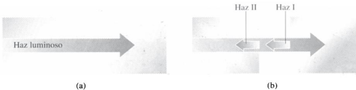
Figura 31. Reflexión interna por dos interfaces. a) Un haz luminoso que se propaga a través de un medio homogéneo denso como el vidrio. b) Al partir y separar el bloque de vidrio, la luz se refleja hacia atrás en las dos nuevas interfaces. El haz I se refleja externamente y el haz II internamente. Idealmente, al volver a juntar los dos pedazos, los dos haces reflejados se anulan recíprocamente (123) .
