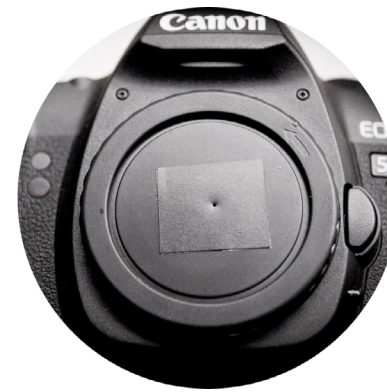
Fig.18 Pinhole con Réflex, Es un modelo hecho con una cámara réflex no importa si es digital o manual, solo se hace el estenopo en la tapa. Recuperado de http://jmbassifotografia.blogspot.com/2012/03/estenopeica-digital_27.html
