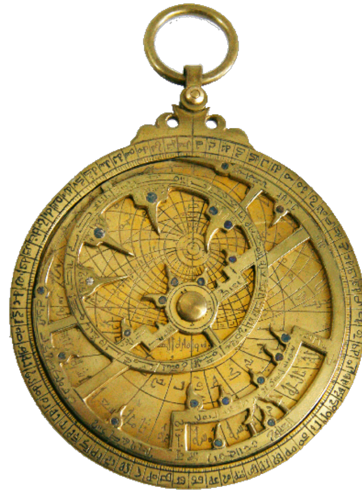
Fig.5 Instrumento Astrolabios , hecho por Ahmad b. Muhammad, es un instrumento astronómico ocupado principalmente para determinar la posición y altura de las estrellas sobre el cielo, así que es de su funcionamiento de donde proviene su nombre que significa buscador de estrellas. Recuperado de https://www.ranm.es/lente/Microscopios/Astronomia/Astronomia04/astrolabios04.html
