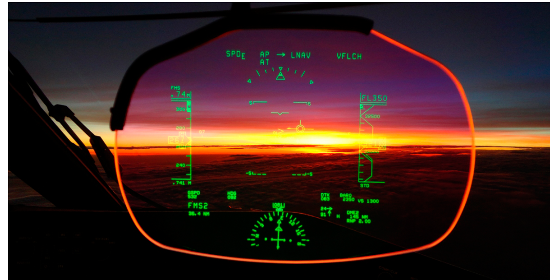
Fig.40 Sistema Head Up Displays (HUDs) de un avión de combate, el sistema funciona al proyectar un holograma sobre un material traslucido en el display del piloto. Recuperado de https://www.transponder1200.com/video-heads-up-display-hud-el-pasado-presente-y-futuro-de-la-aviacion/
