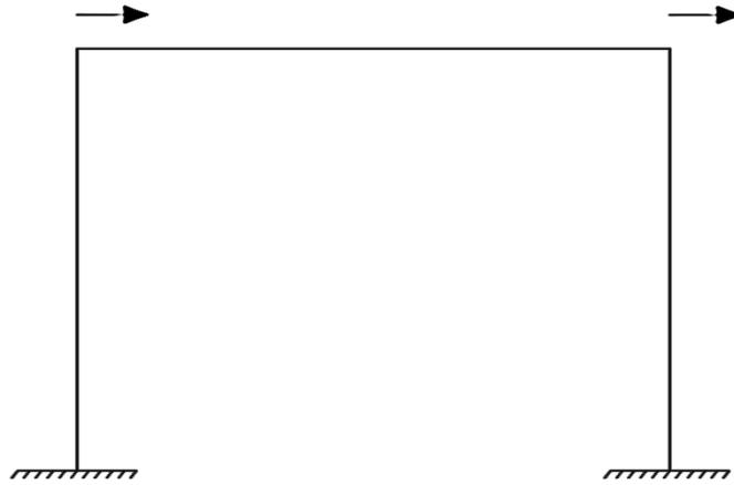
*Figura III.6. Estructura idealizada con la losa infinitamente rígida a flexión y ambas columnas infinitamente rígidas axialmente.*
