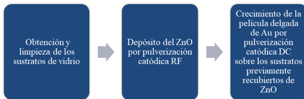
Figura 2.1: Etapas del proceso para generar los sustratos bicapa de películas delgadas sobre vidrio para generar nanopartículas de Au sobre ZnO.
