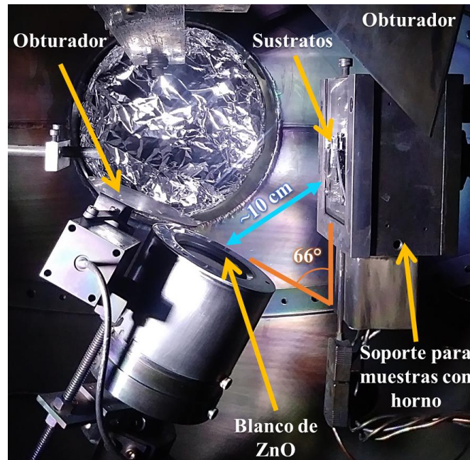
Figura 2.2: Configuración utilizada para realizar el crecimiento de películas delgadas de ZnO mediante sputtering RF.
