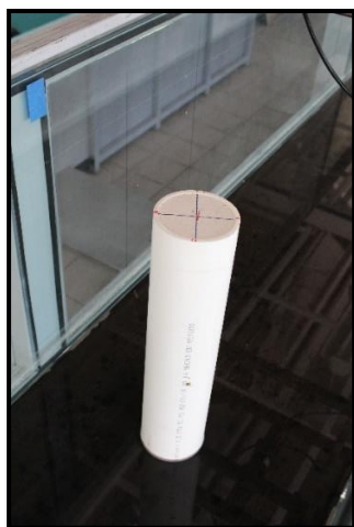
Figura 4.4 Cilindro para generar las calles de von Kármán
