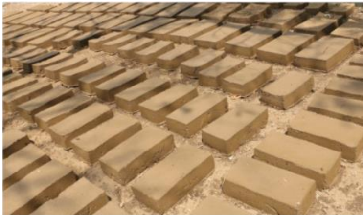
Imagen 4.23.- Obtenida de (Laboratorio de Procedimientos y Sistemas Constructivos Tradicionales, 2019). Ladrillos de adobe en proceso de secado al aire libre.
