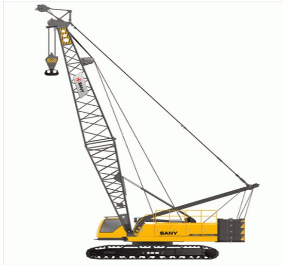
Figura 3.6. Grúa móvil de pluma rígida<sup>19</sup>.
