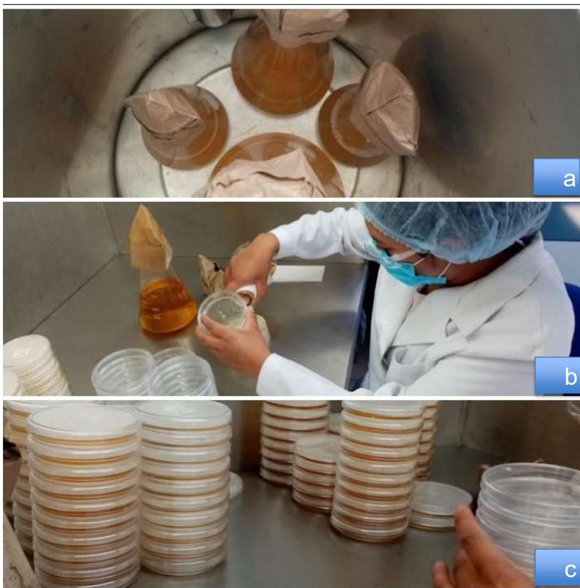
A) Agar Soya Trypticaseina dentro del autoclave, B) Vaciado del medio de cultivo en cajas Petri para su gelificación, C) Pilas de cajas Petri gelificadas. Fuente: Propia.
