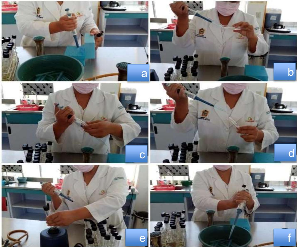
A) Toma de punta estéril con la micropipeta de 1000  $\mu\text{L}$ , B) Pipeteo de la solución madre, C) Se le coloca la tapa de rosca y se desenrosca el siguiente tubo, D) La solución contenida en la micropipeta se vierte en el tubo dos, E) El tubo se coloca en el Vórtex. , F) La punta utilizada se desecha. Fuente: Propia.
