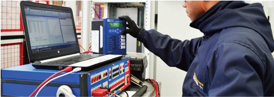
*Figura 2.19* Pruebas a relés de protección. Industrias ELECTRICOL (2020)
