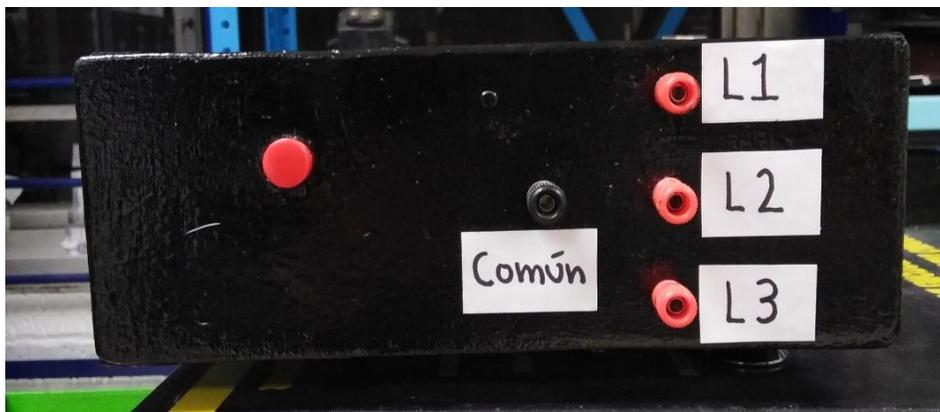
*Figura 4.9* Módulo de resistencias para simulación de fallas (vista frontal).
