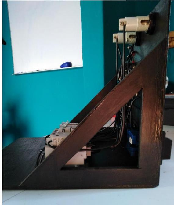
*Figura 4.6* Módulo didáctico de simulación de interruptor de potencia real.
