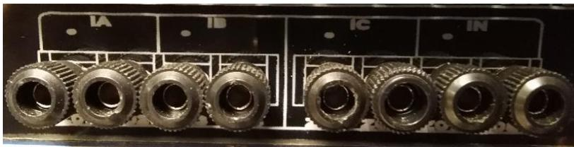
*Figura 3.3* Bornes de conexión para transformador de corriente. Archivo Personal (2019)
