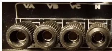
*Figura 3.4* Bornes de conexión para transformador de potencial Archivo Personal (2019)
