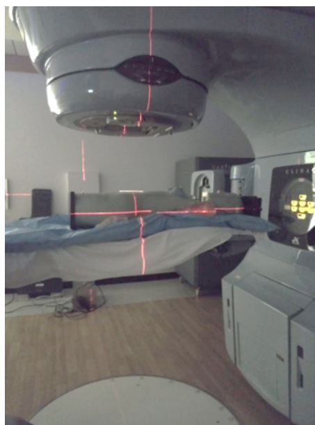
Figura 3.14: Alineación del maniquí utilizando los láseres, con una SSD de 95.0 cm.
