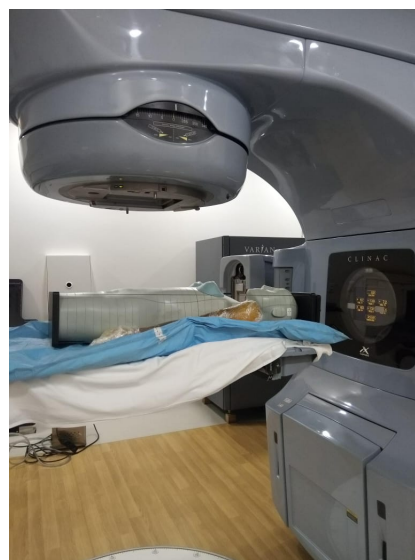
Figura 3.16: Maniquí en la mesa de tratamiento del acelerador lineal antes de su irradiación.
