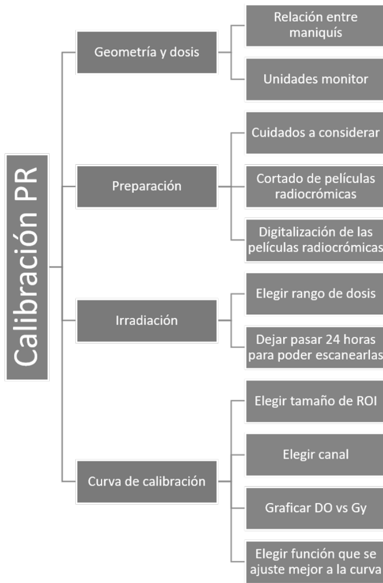
Figura A.13: Esquema donde se muestran las secciones y puntos más importantes del protocolo de calibración.
