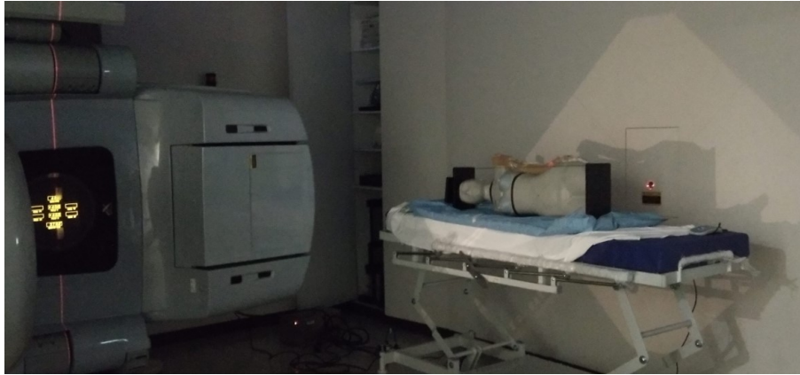
Figura 3.21: Maniquí antropomórfico durante el tratamiento a una SSD de 300 cm, campo 40 cm \times 40 cm, en posición decúbito lateral, campo anterior.
