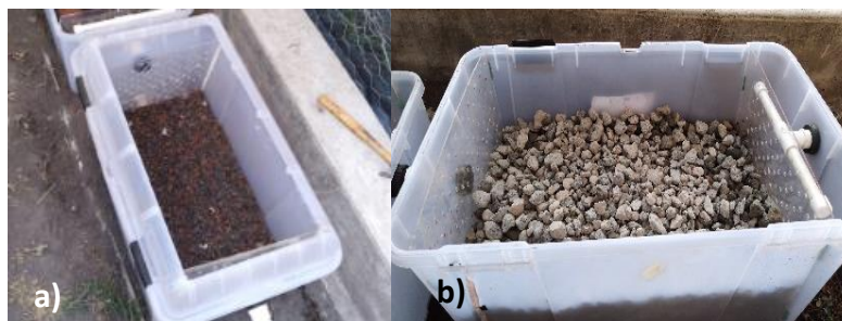
Figura 3. 16 a) Empaque horizontal del estrato de tezontle, b) empaque de andesita (Fecha: 15 de marzo 2019)
