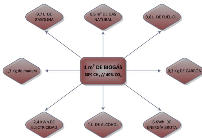
Ilustración 86: Equivalencia de energías dado el porcentaje de metano.
