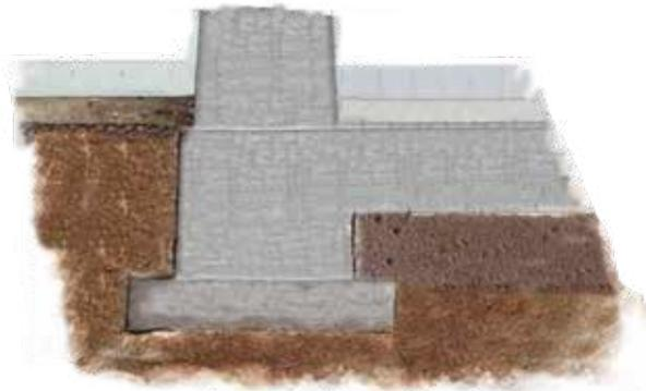
En el caso de elementos como los módulos sanitarios y de vigilancia se optó por un sistema de muros de carga con tabique multiperforado y castillos ahogados. La cimentación será de zapata corrida de concreto armado.
