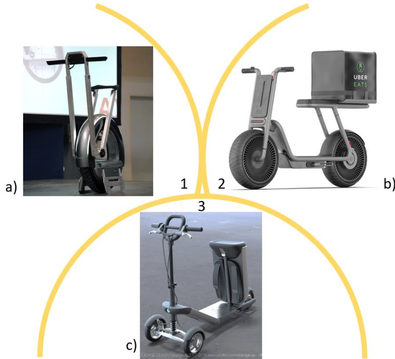
Figura 4.8 Clasificación de vehículos según su número de ruedas: a) Audi monocycle [59], b) AIRA [60], c) Backpack Electric Scooter [61].
