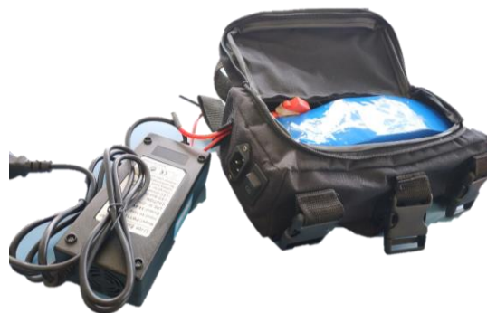
Figura 5.8 Batería Li-ion de 48 V a 10 Ah [71].
