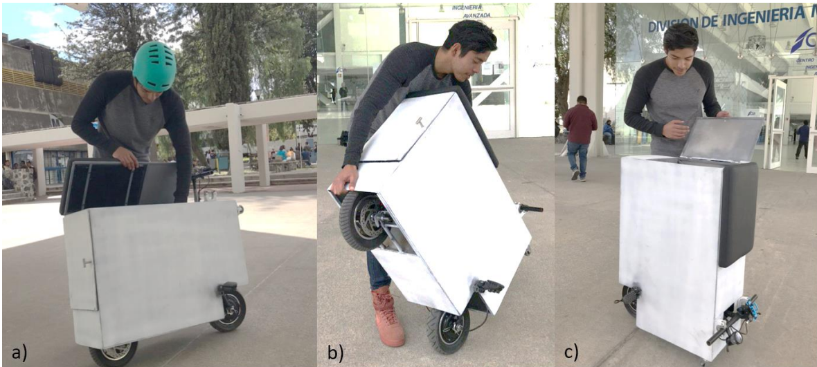
Figura 5.22 a) Extracción de paquetes en modo vehículo por el asiento b) Convirtiendo al vehículo en maleta, c) extracción de paquetes en modo maleta por la parte superior.
