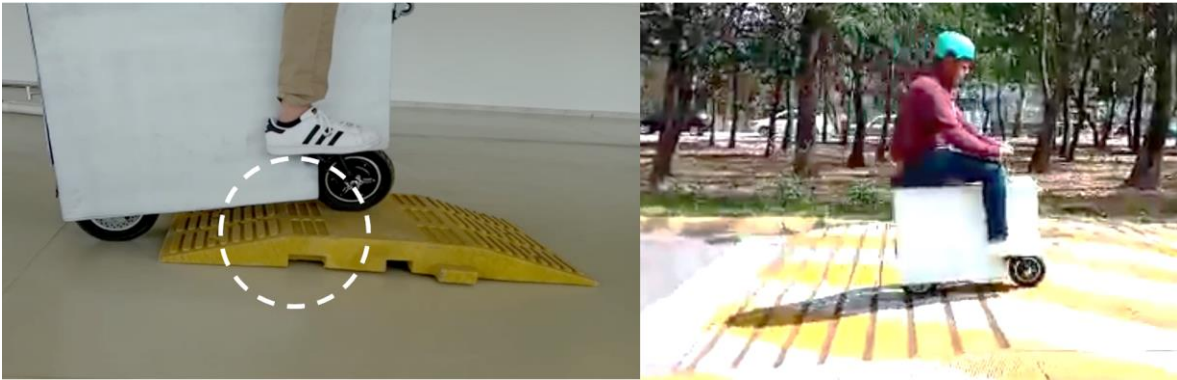
Figura 5.25 VUMi 2 pasando tope a) del laboratorio, b) del campus universitario.
