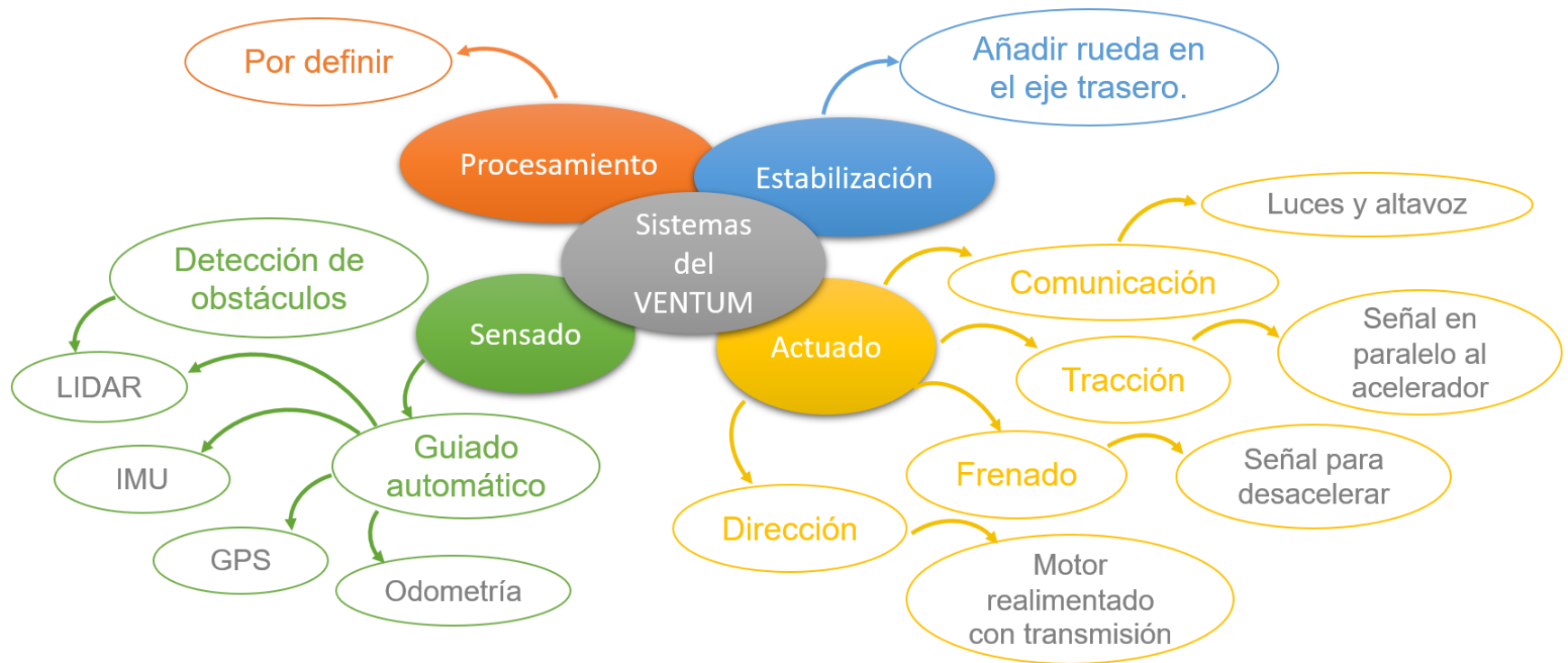
Figura 6.32 Síntesis de los sistemas implementados en VENTUM.
