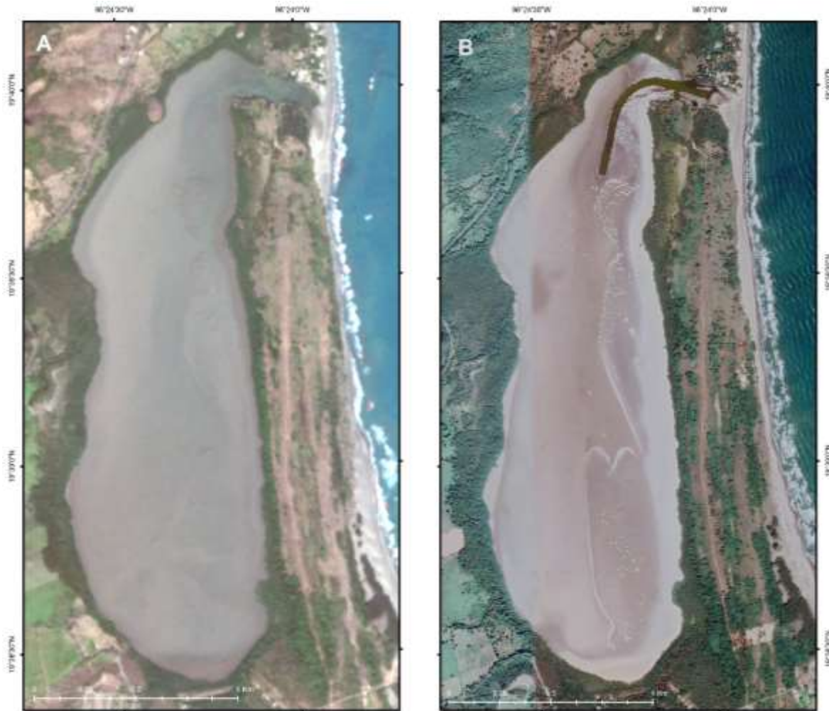
Fig. 36. Evolución del azolvamiento de la laguna El Llano: A) Imagen satelital RAPIDEYE 2011, la laguna ya evidencia la sedimentación, la coloración es oscura y la capa de agua es somera. B) Imagen satelital Google Earth 2019, la laguna ya se encuentra azolvada en su totalidad y en la porción de la boca se abrió un canal. Elaboración propia.
