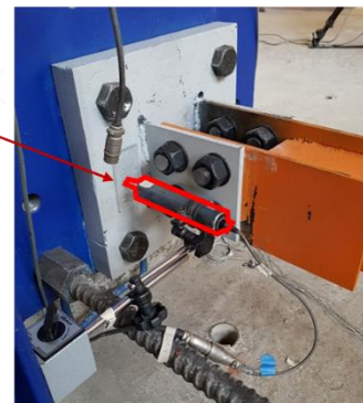
Figura 3.11: Distribución y detalle de transductores de desplazamiento.
