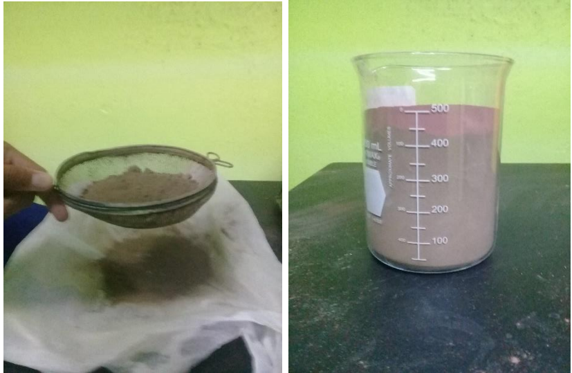
Figura 27. Tamizado y dosificación de la muestra. Fotografía propia, 2020.
