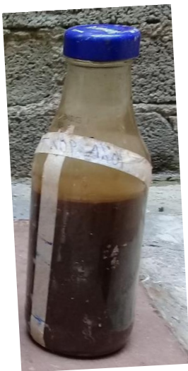
Figura 28. Ensayo de sedimentación 90% Tepetate y 10% Arcilla. Fotografía propia, 2020.
