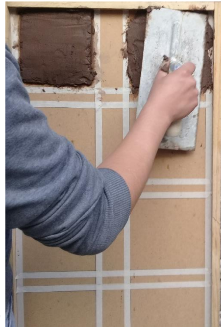
Figura 30. Ensayo de retracción 90% Tepetate y 10% Arcilla. Fotografía propia, 2020.
