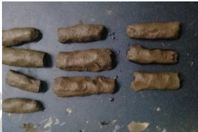
Figura 29. Ensayo de cohesividad 90% Tepetate y 10% Arcilla. Fotografía propia, 2020.
