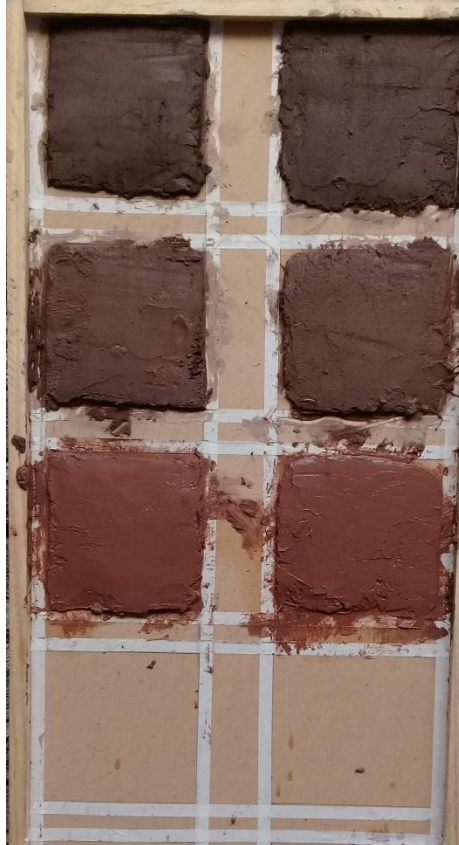
Figura 37. Ensayo de retracción 50% Tepetate y 50% Arcilla.
