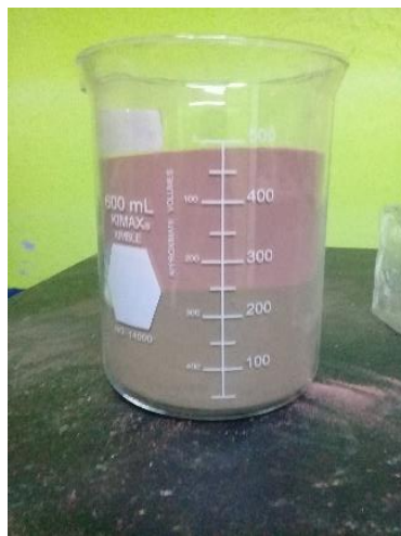
Figura 34. Dosificación de la muestra 50% de tepetate - 50% arcilla. Fotografía propia, 2020.
