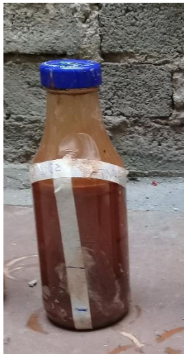
Figura 35. Ensayo de sedimentación 50% Tepetate y 50% Arcilla. Fotografía propia, 2020.
