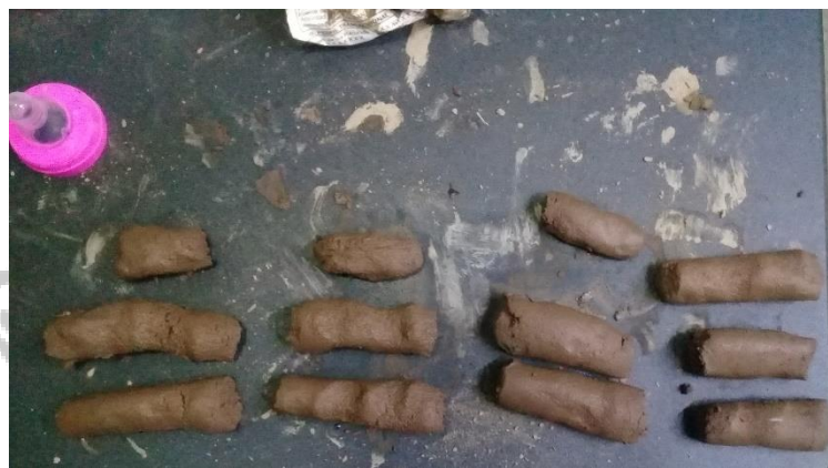
Figura 32. Ensayo de cohesividad 70% Tepetate y 30% Arcilla. Fotografía propia, 2020.
