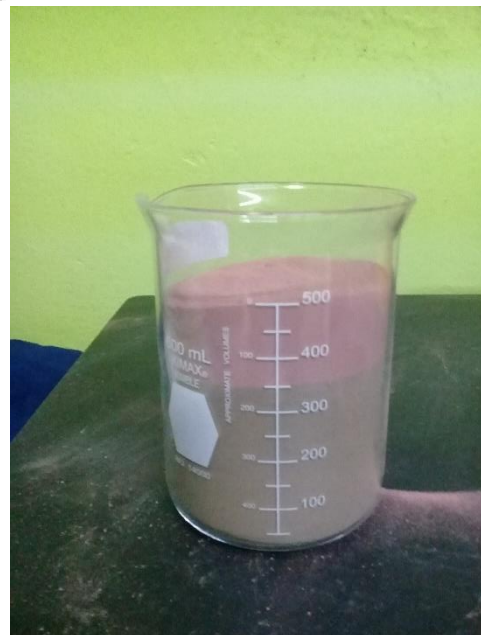
Figura 31. Ensayo de sedimentación 70% Tepetate y 30% Arcilla; dosificado de la muestra. Fotografía propia, 2020.
