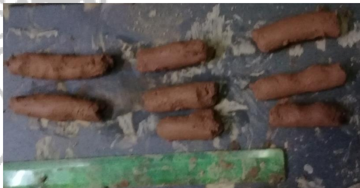
Figura 36. Ensayo de cohesividad 50% Tepetate y 50% Arcilla. Fotografía propia, 2020.
