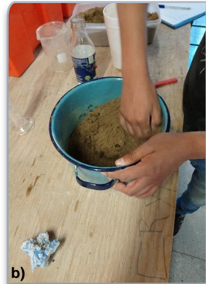
Figura 20. Preparación de la muestra para el ensayo de expansión y retracción. Fotografía propia, 2019.
