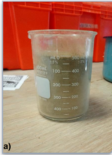
Figura 20. Preparación de la muestra para el ensayo de expansión y retracción. Fotografía propia, 2019.
