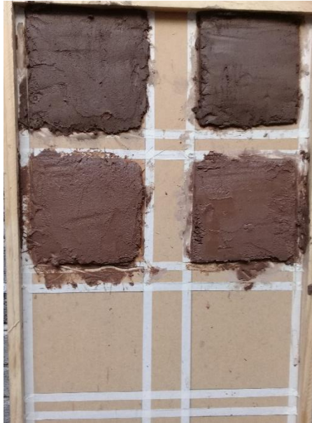
Figura 33. Ensayo de retracción 70% Tepetate y 30% Arcilla. Fotografía propia, 2020.
