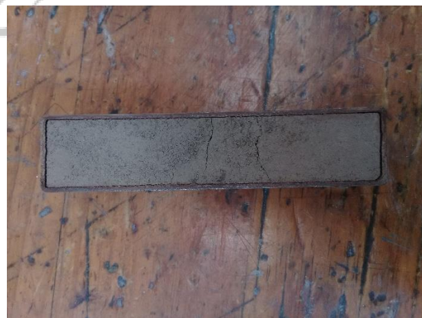
Figura 26. Molde de contracción lineal con tierra de Ecatzingo, Estado de México. Fotografía propia, 2019.
