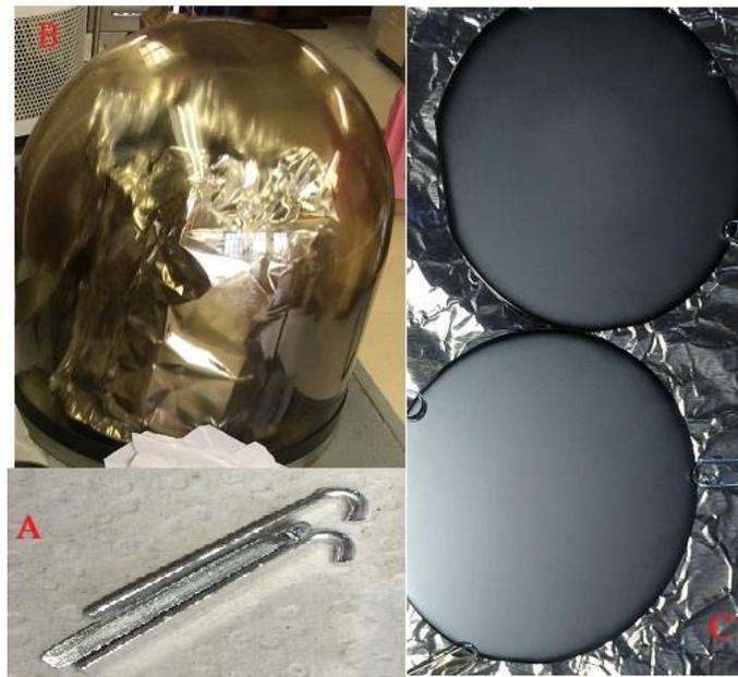
**Figura 3.2.** Depósito de películas de aluminio en obleas de silicio cristalino por CVD. A: bastones de aluminio que serán evaporados. B: cámara de vacío sellada. C: obleas de silicio depositadas.
