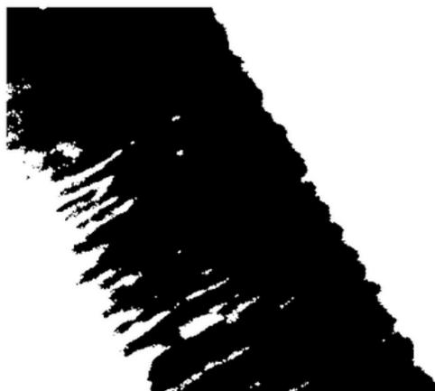
Figura 3.15. Micrografía binarizada con filtros de dilatación y erosión.
