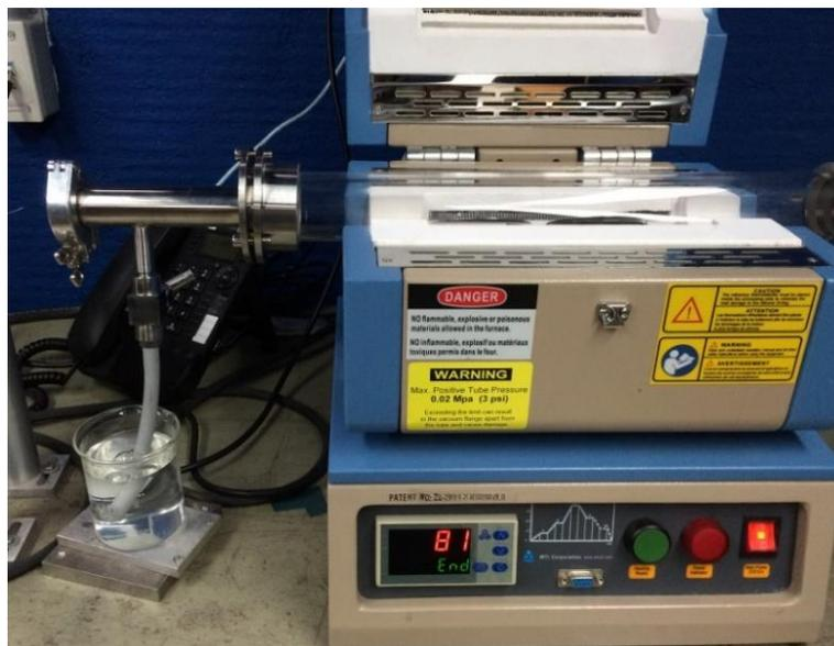
Figura 3.3. Horno electrónico donde se realizó el tratamiento térmico de las obleas de silicio con depósito de aluminio.
