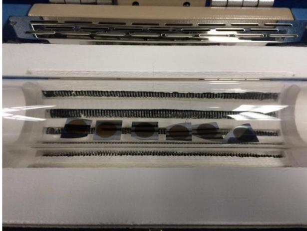
Figura 3.9. Tratamiento térmico de las muestras de silicio poroso en un horno tubular.
