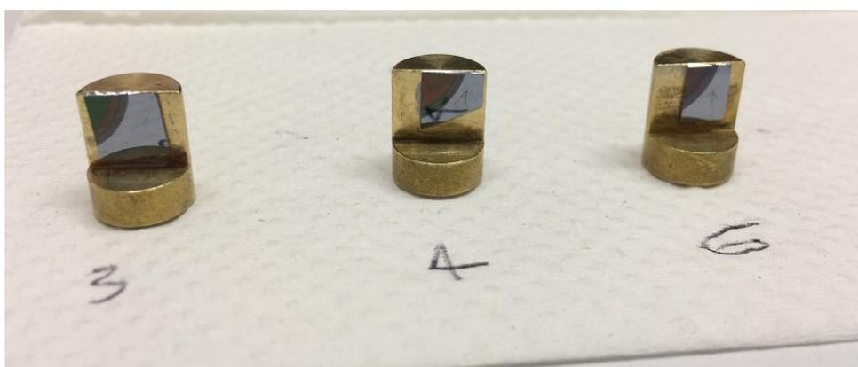
**Figura 3.12.** Muestras de PSi montadas y adheridas para el análisis por SEM.
