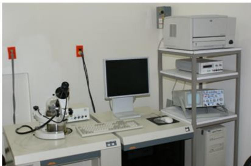
Figura 4.4: Microscopio de fuerza atómica JEOL JSPM4210
