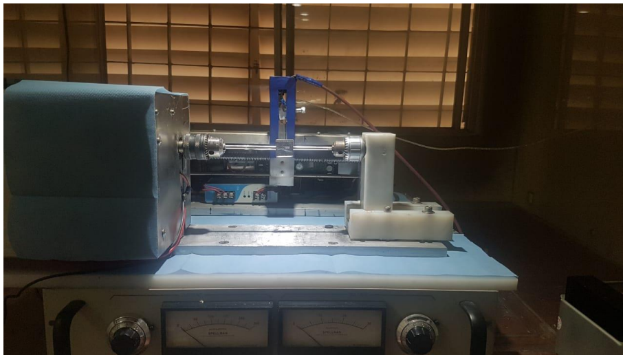
Figura 22. Equipo de electrohilado. El equipo con el que se cuenta en el “CMN 20 de Noviembre, ISSSTE” se le fue adaptada a la varilla colectora un cubreobjetos de vidrio, para la recolección de las nanofibras que serían usadas para el cultivo celular.
