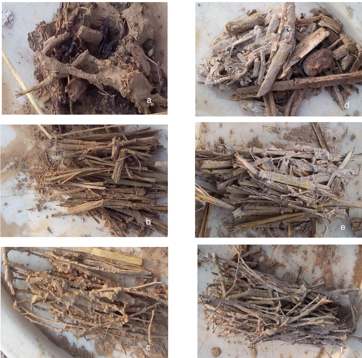
Figura 26. Las imágenes mostradas como a, b y c, muestran la reacción de las fibras al agregar mucílago de maguey, siendo la muestra c que utiliza ramas de arbusto la más estable de las tres. Para el caso del empleo de cal hidratada, se observa un desempeño más favorable, salvo el caso d, correspondiente al empleo de paja de haba. Fuente: Autor.
