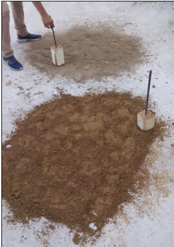
Figura 19. Proceso de cuarteo del suelo Fuente: Autor. Lugar: FES Aragón. Año: 2019
