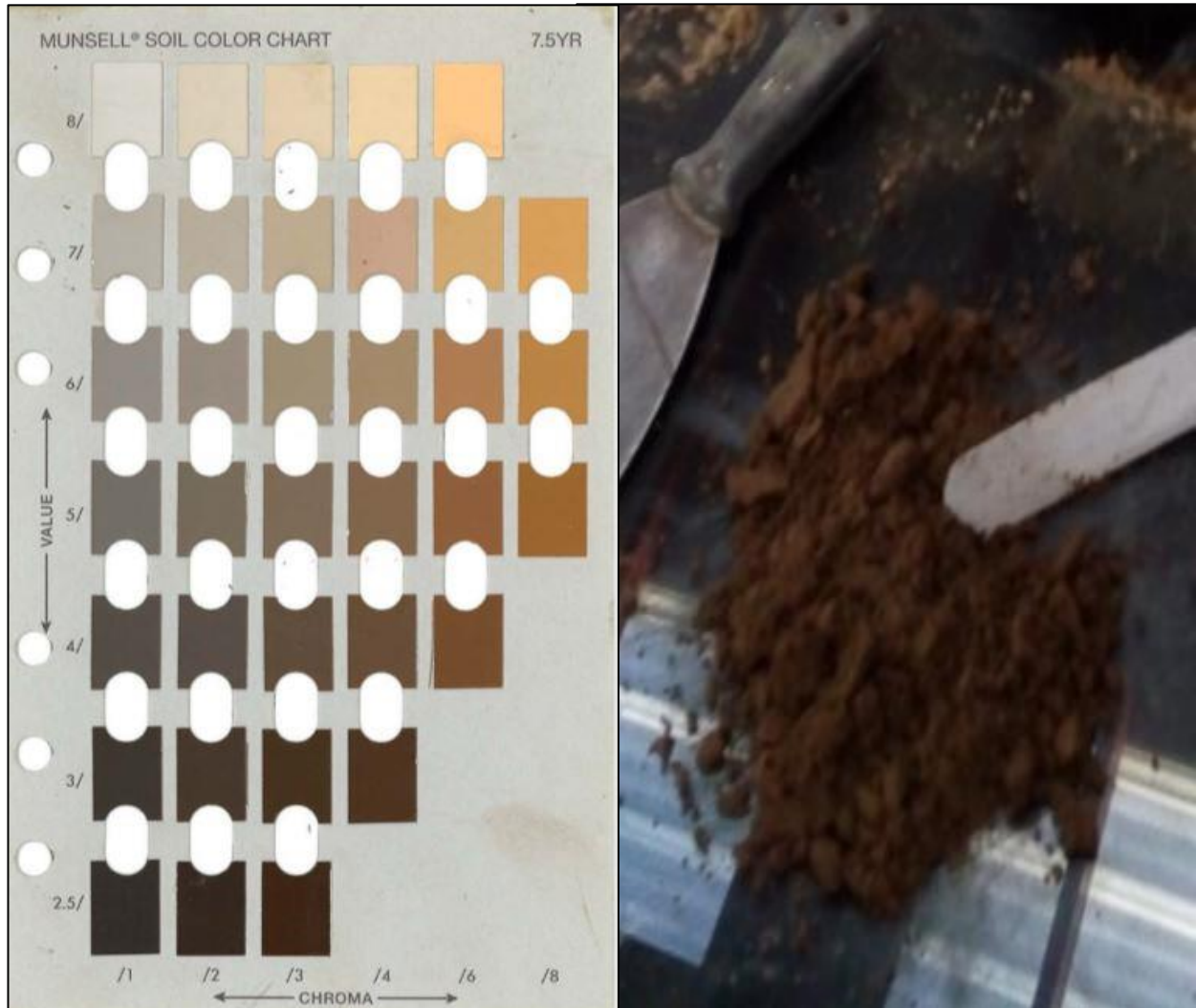
Figura 15. De igual manera, pero tras humectar la muestra se procede a su verificación litocromática.
