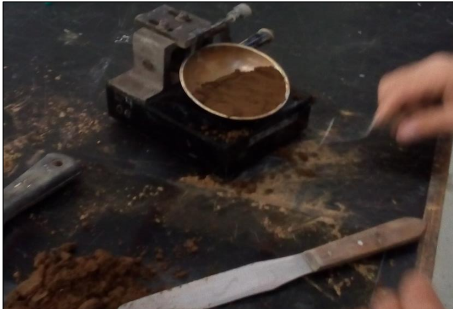
Figura 21. Golpeo en copa casagrande de la muestra humectada de suelo. Fuente: Autor. Lugar: FES Aragón Año: 2019
