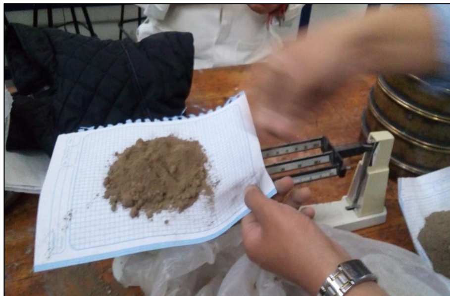
Figura 23. Peso del suelo en balanza granataria. Fuente: Autor. Lugar: FES Aragón. Año: 2020
