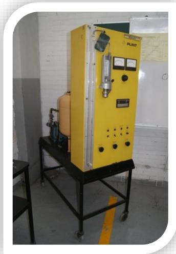
**Figura 17.** Equipo de radiación y convección de energía. (Blog FES Aragón UNAM Laboratorio Térmica y Fluidos L2, 2019)
