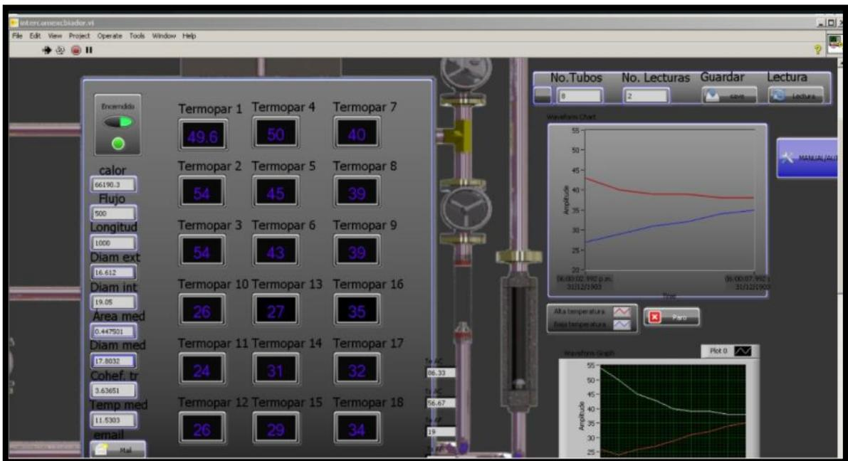
**Figura 40.** Panel frontal ejecutando una prueba. (Elaboración propia)
