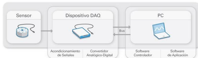
**Figura 10.** Partes de un sistema DAQ. (National Instruments, 2021)
