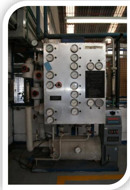
**Figura 18.** Equipo de transferencia de calor por radiación y convección de energía. (Blog FES Aragón UNAM Laboratorio Térmica y Fluidos L2, 2019)
