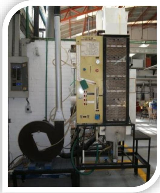
**Figura 16.** Equipo Torre de enfriamiento. (Blog FES Aragón UNAM Laboratorio Térmica y Fluidos L2, 2019)
