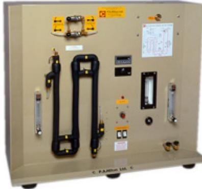
**Figura 14.** Intercambiador de calor de tubo concéntrico. (PA Hilton, 2020)
