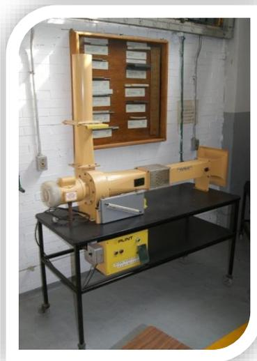
**Figura 15.** Equipo intercambiador de calor de flujo cruzado. (Blog FES Aragón UNAM Laboratorio Térmica y Fluidos L2, 2019)
