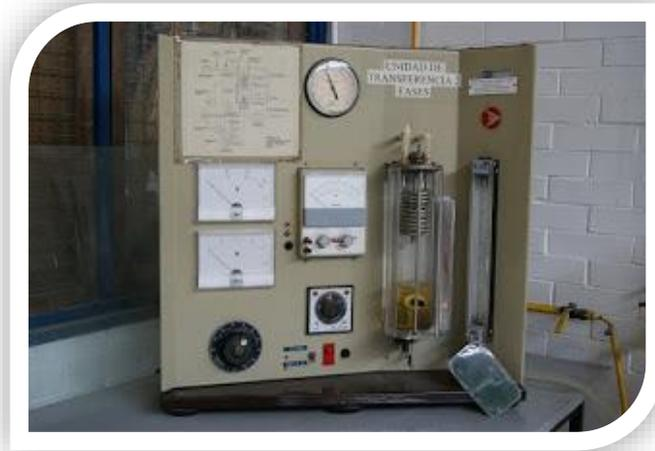
**Figura 15.** Equipo Intercambiador de calor de dos fases. (Blog FES Aragón UNAM Laboratorio Térmica y Fluidos L2, 2019)
