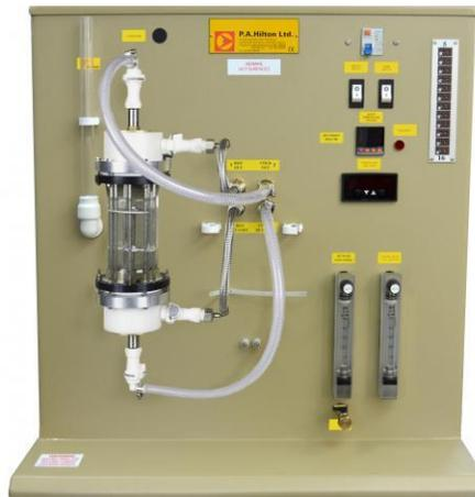
**Figura 13.** Unidad H102E Servicio de Intercambiador de Calor. (PA Hilton, 2020)
