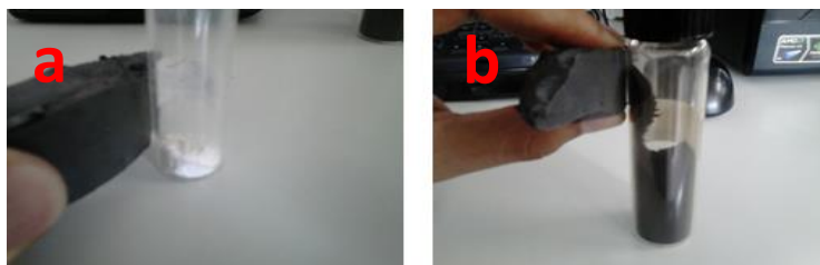
Figura 5. a) Nanotubos de haloisita; b) Magnetita/nanotubos de haloisita (magnética).
