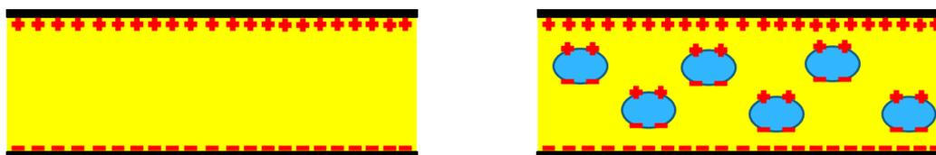
Figura 49 Comparación entre la polarización tradicional y la polarización Maxwell Wagner Sillars.
