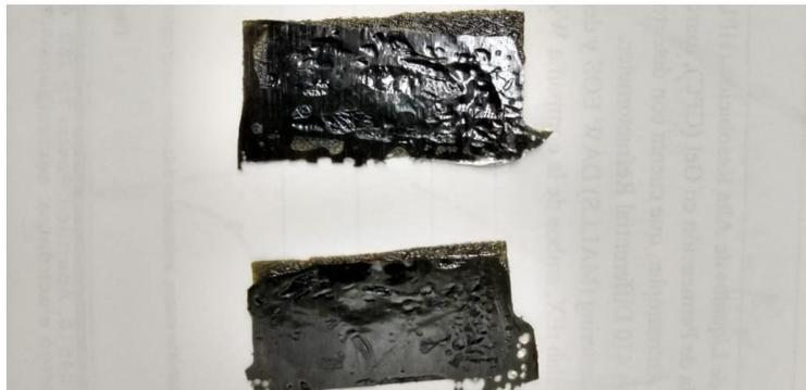
Figura 96 capacitores estructurales para pruebas mecánicas.
