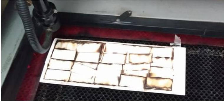
**Figura 77** Tela de CNT cortada con láser.
