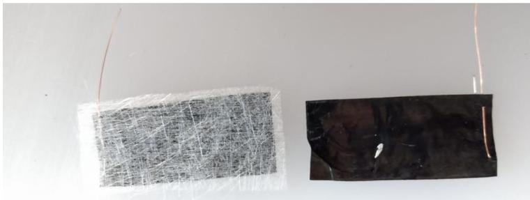
**Figura 78** Separador de fibra de vidrio y electrodos de CNT.
