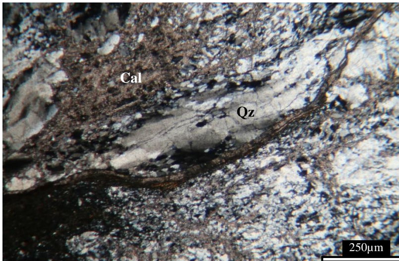
Figura 25. Fotomicrografía de HUE-1 en donde se observan estructuras de recrystalización por rotación de subgranos en cristales de cuarzo (nícoles cruzados y objetivo 10x).
