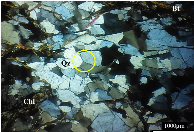
Figura 46. Fotomicrografía de MLCO-2 en donde se observan juntas triples de 120° entre cristales de cuarzo (nícoles cruzados y objetivo 4x).
