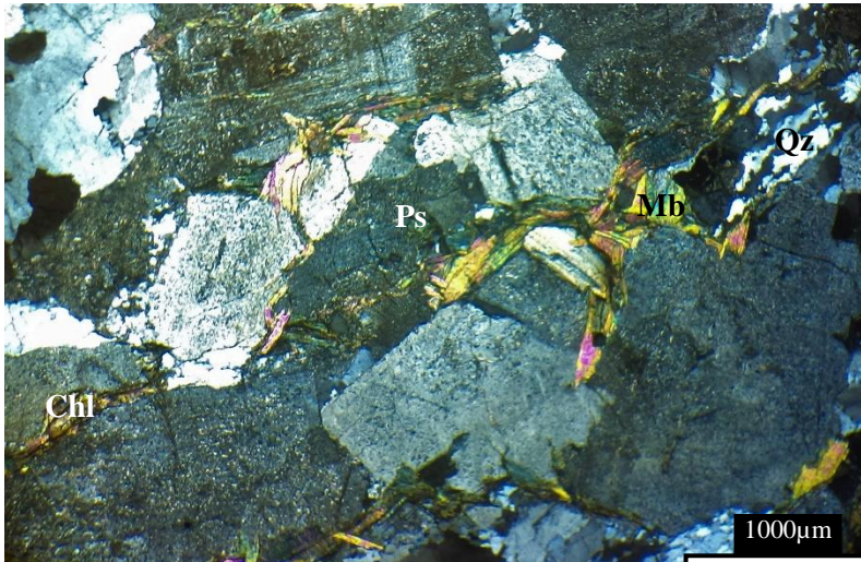
Figura 63. Fotomicrografía de TOT-1 en donde se observa la abundancia de la plagioclasa con respecto a las demás fases minerales (nícoles cruzados y objetivo 4x).
