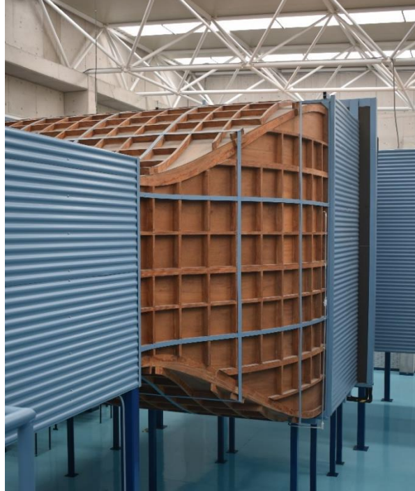
Figura 3.13 Cono de contracción
