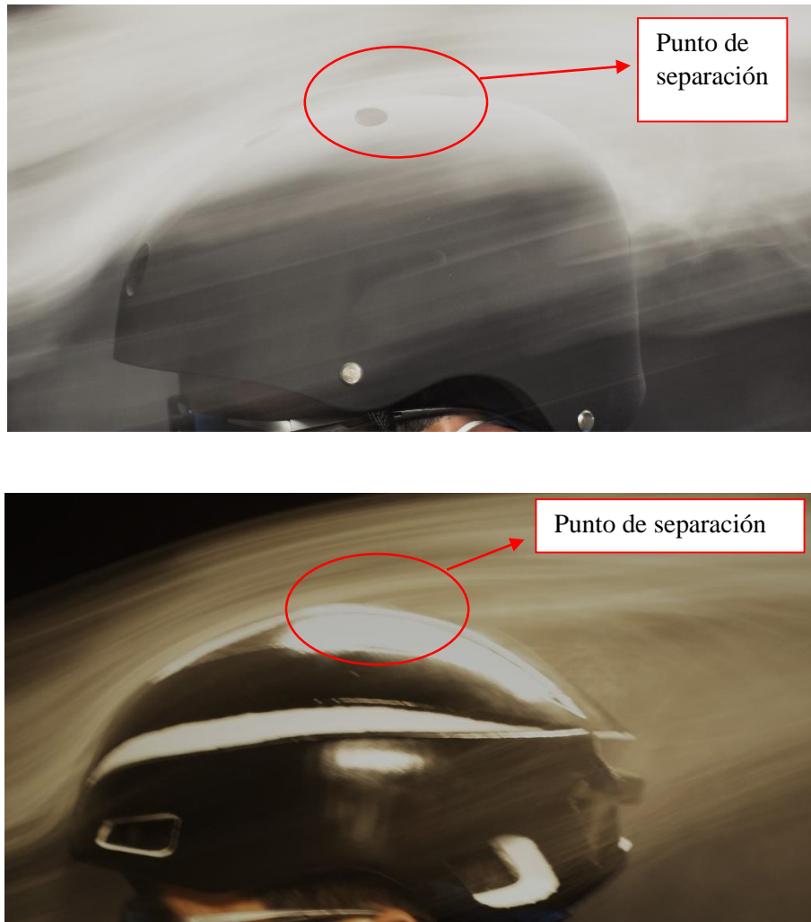
Figura 5.7 Separación de la corriente en modelo de referencia (arriba) y propuesto (abajo)
