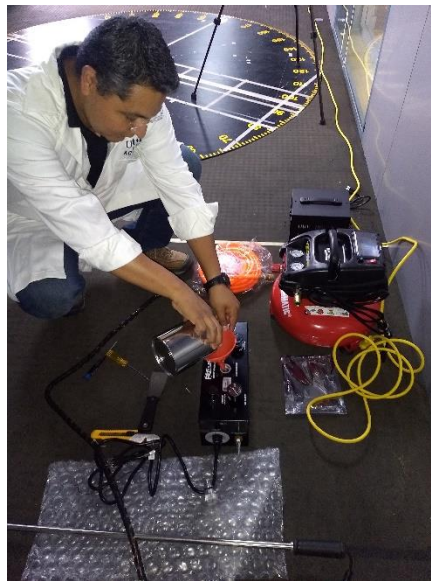
Figura 5.6 Ingreso del fluido mineral a la unidad de control
