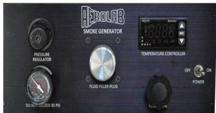
Figura 5.5 Unidad de control
