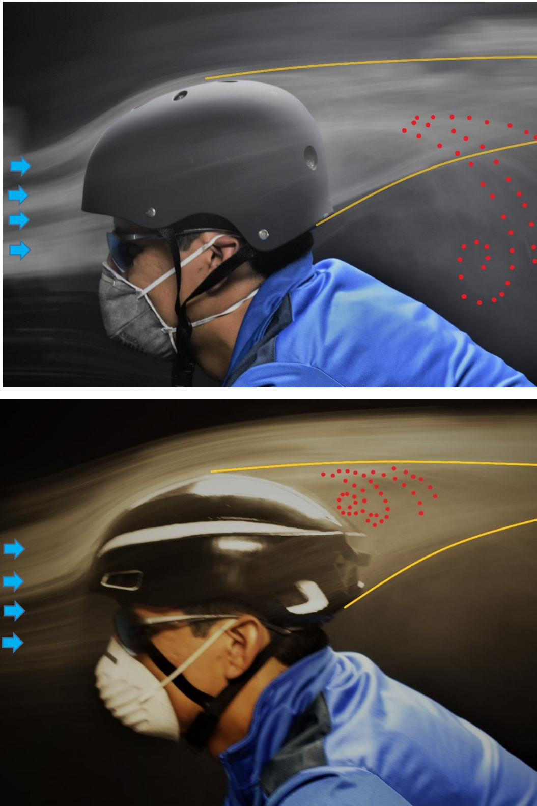
Figura 5.8 Comparación de estelas; arriba modelo de referencia y abajo propuesta
