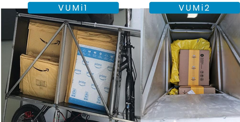
Figura 7.34 - Cambio del contenedor (aumento de volumen de carga en VUMi2).
