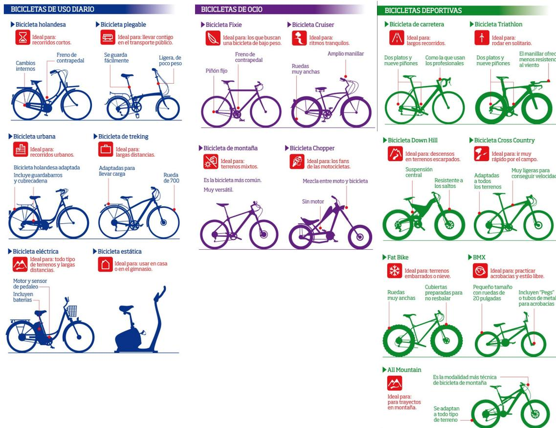
Figura 7. 67 - Tipos de bicicletas y sus usos [107].
