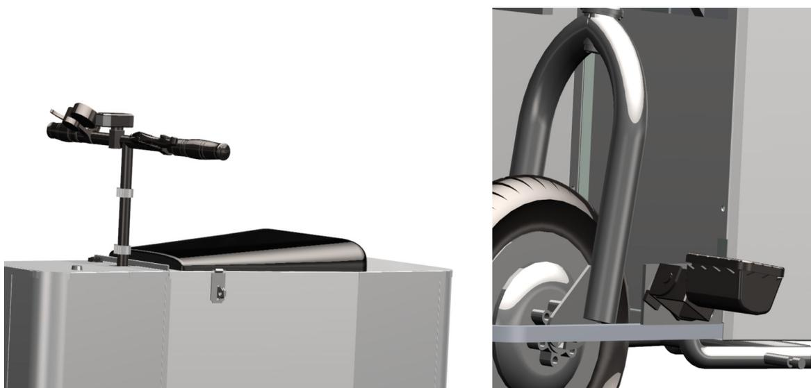
Figura 7.77 – Sistema de soporte para el usuario VUMi3.
