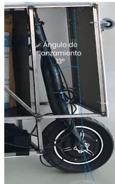
Figura 7. 25 - Medición del ángulo de lanzamiento de VUMil.
