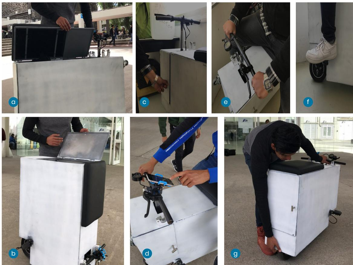
Figura 7.53 - a) Punto de contacto en puerta superior VUMi2; b) Punto de contacto en puerta posterior VUMi2; c) Punto de contacto en puerta de compartimiento batería-controlador; d) Punto de contacto con celular en soporte en VUMi2; e) Punto de contacto en manubrio durante el viaje en VUMi2; f) Punto de contacto con reposapiés durante traslado en VUMi2; g) Punto de contacto en parte posterior - inferior para subir/baja VUMi2 de la camioneta o convertirlo a modo maleta.
