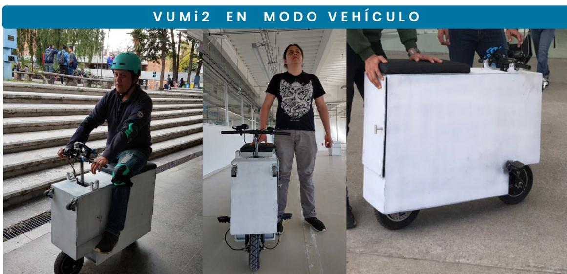
Figura 7.41 - Prototipo VUMi2 en modo vehículo.
