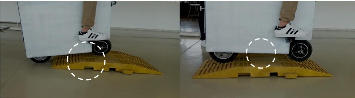
Figura 7. 44 - Prueba de VUMi2 en topes de polietileno.
