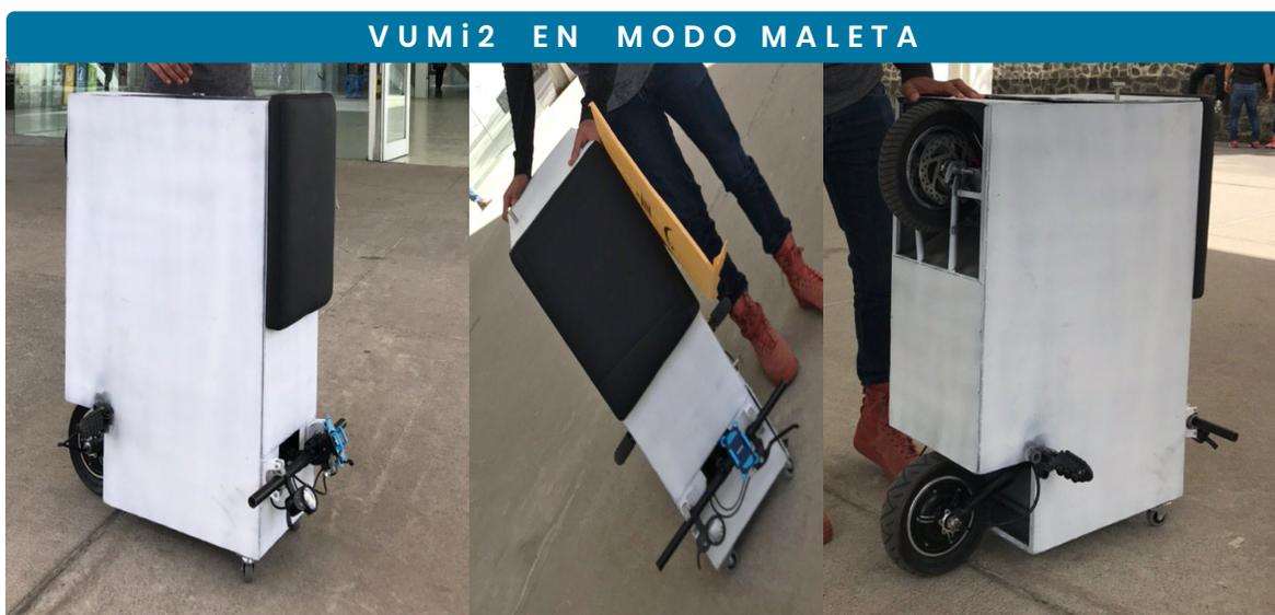
Figura 7.42 - Prototipo VUMi2 en modo maleta.
