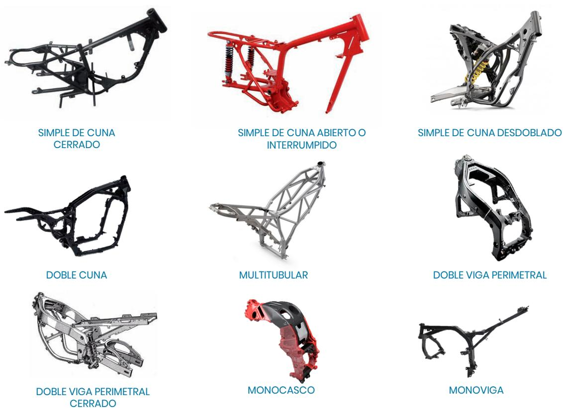
Figura 7.14 - Tipos de cuadros para la fabricación de motocicletas [97].
