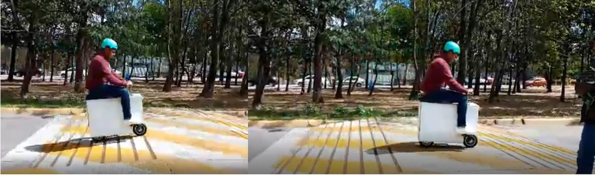
Figura 7. 43 - Prueba de VUMi2 en topes de concreto.
