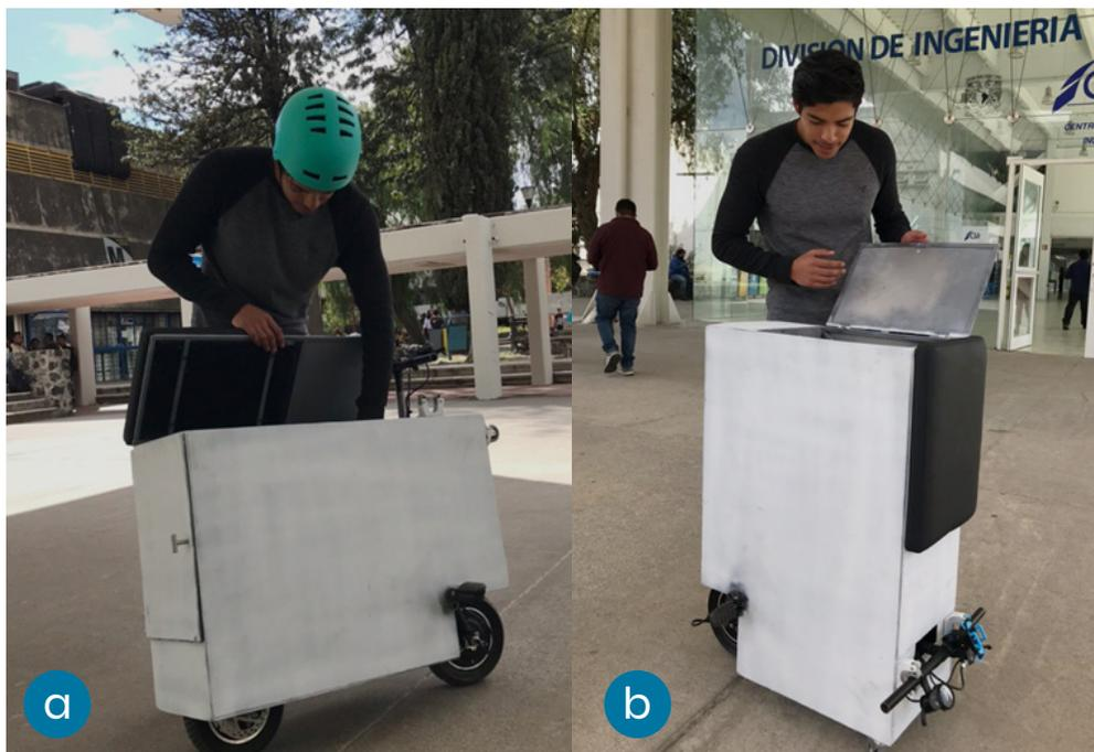
Figura 7 . 37 - a) Acceso superior a compartimiento en VUMi2; b) Acceso posterior a compartimiento en VUMi2.
