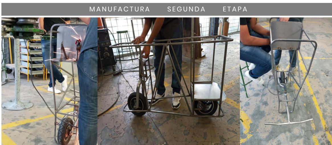
Figura 7. 80 - Manufactura de dirección, horquilla trasera y frenado VUMi3.
