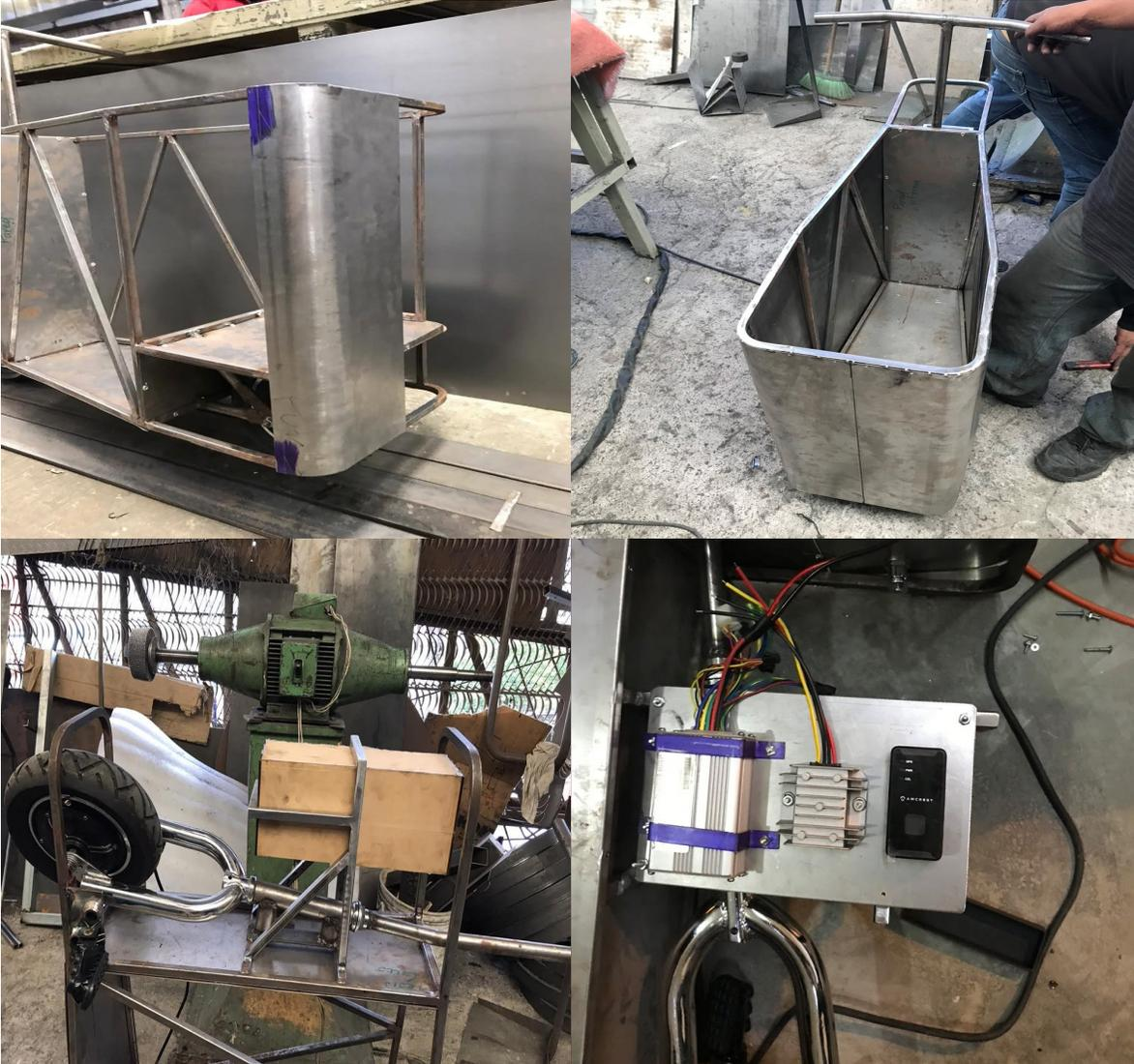
Figura 7. 81 - Manufactura de carcasa, estructura de batería y platina VUMi3.
