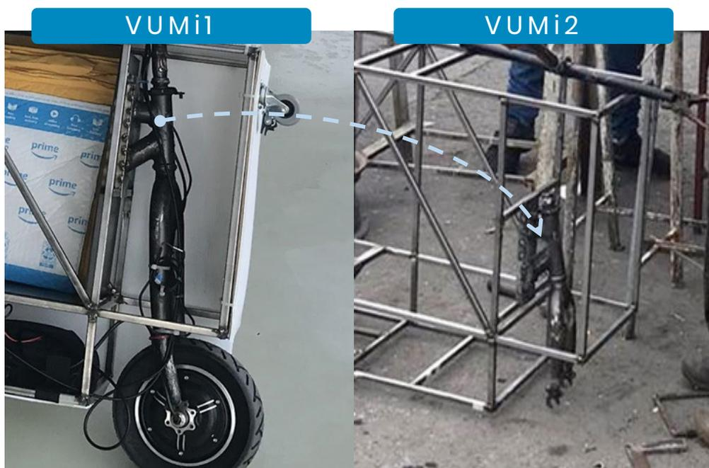
Figura 7.35 - Cambio en el sistema direccional en VUMi2.
