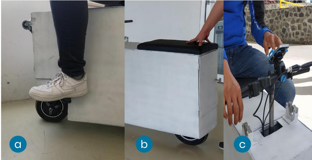
Figura 7. 39 - a) Implementación de reposapiés en VUMi2 ; b) Implementación de asiento de esponja en VUMi2 ; c) Implementación soporte de celular en VUMi2..
