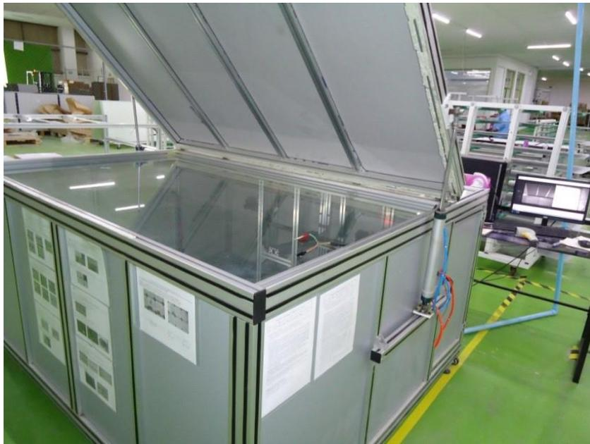
Figura 4-12 Máquina de electroluminiscencia.
