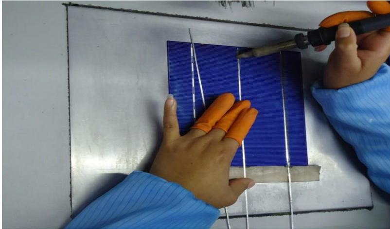
Figura 4-6 Soldadura individual.
