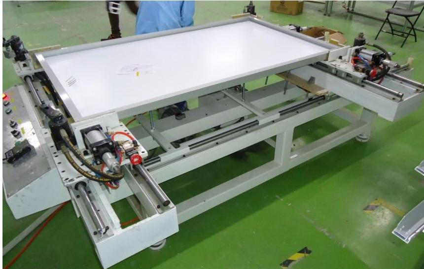
Figura 4-16 Máquina de presión neumática.
