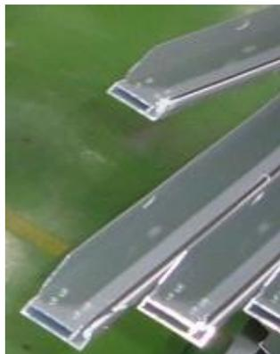
Figura 4-15 Colocado de silicón en ranuras de marcos.
