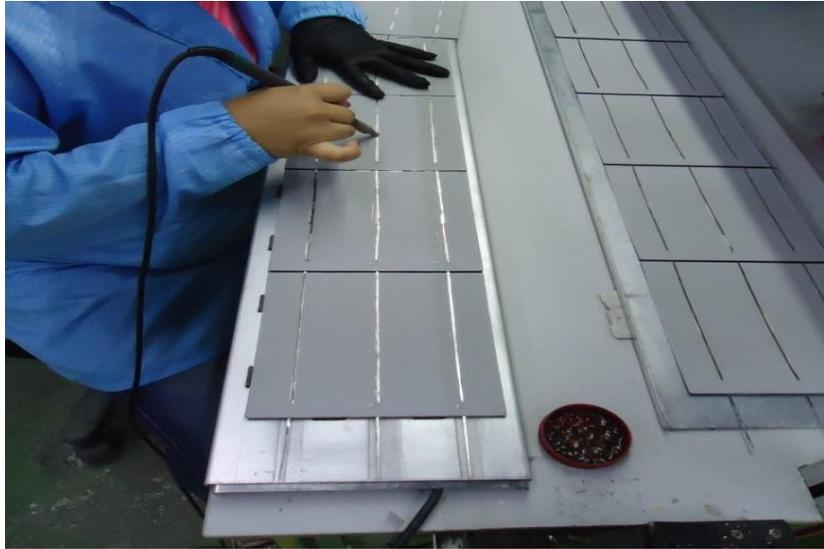
Figura 4-7 Soldadura en cadena.
