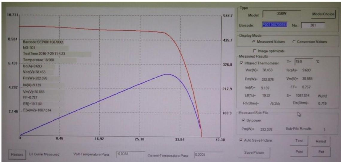
Figura 4-18 Monitor de simulador solar.
