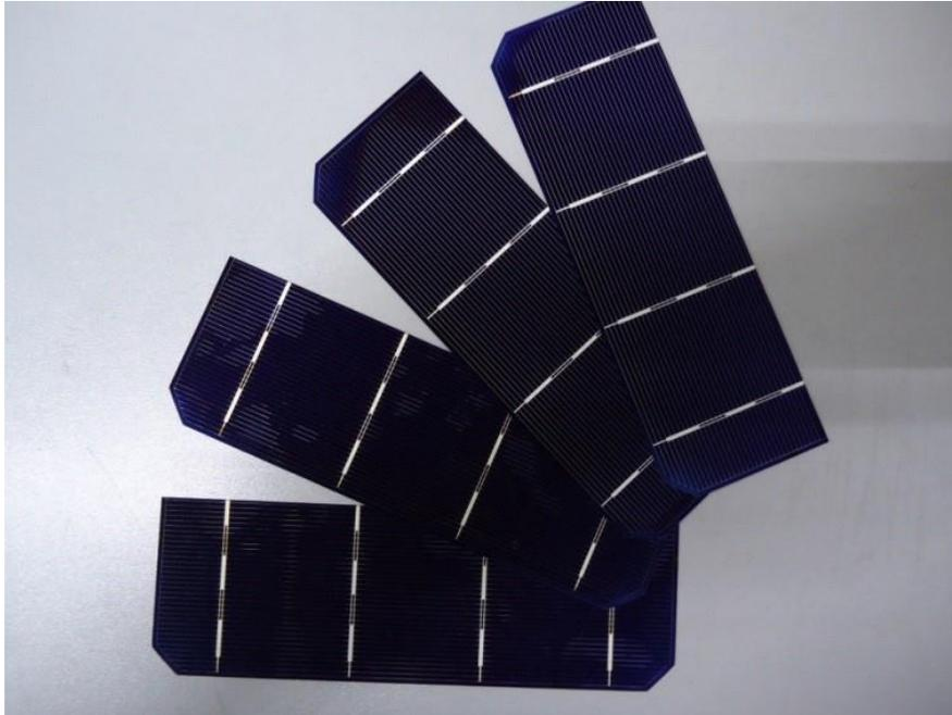
Figura 4-3 Corte de celdas.
