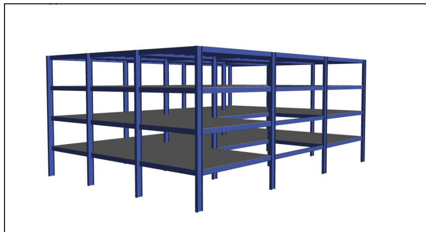
Figura 5.14 Modelo completo con losa propuesta No. 5 en programa E-tabs.
