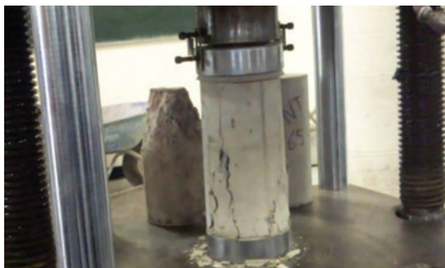
Fig. 4. Prueba de resistencia a Compresión en cilindro concreto [I-4]
