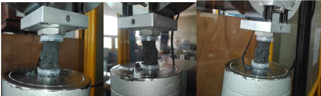
Figura 5.3 Imágenes de las probetas al finalizar la prueba de compresión (Probeta 2).
