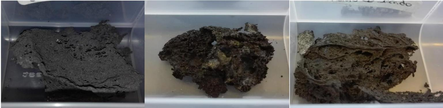
**Figura 4.4** Imagen de las muestras obtenidas con 390, 540 y 240 minutos de secado previo.
