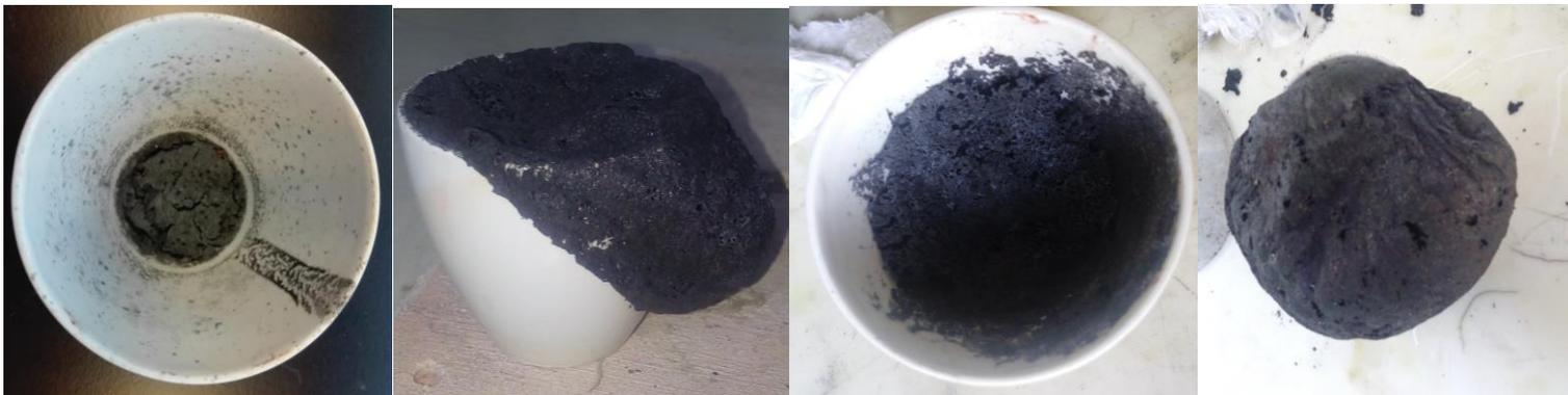
**Figura 4.5** Imagen de las muestras 7, 8 (tratamiento isotérmico de 10 min), 9, 10 (tratamiento isotérmico de 20 min) acorde a la **Tabla 4.8**.
