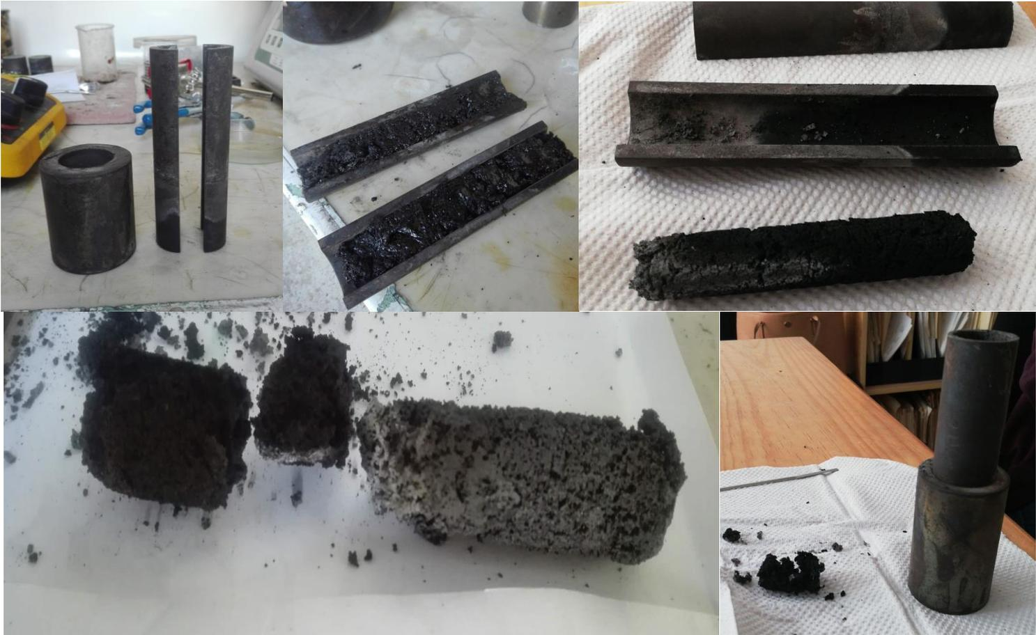
Figura 4.13 Imagen de las muestras colocadas en los tubos de acero.
