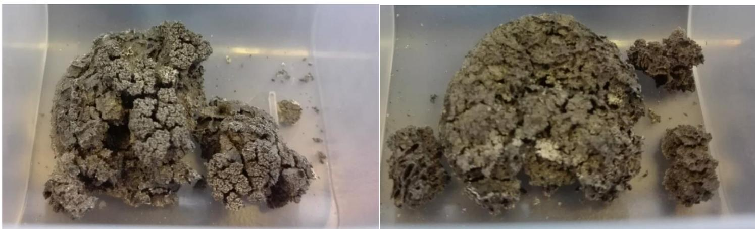
**Imagen 4.9** Imágenes de las muestras calcinadas con secado previo en parrilla, muestra 20 y 21 **Tabla 4.12**.
