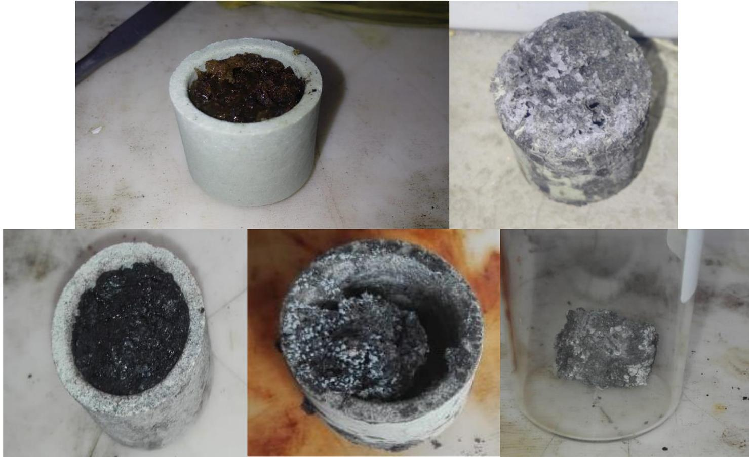
**Figura 4.12** Imágenes superiores, muestra 27, consistencia del gel antes del proceso de calcinado y sólido obtenido posterior al calcinado. Imágenes inferiores, muestra 28, consistencia del gel antes del proceso de calcinado y sólido obtenido posterior al calcinado dentro del crisol y fuera del crisol.
