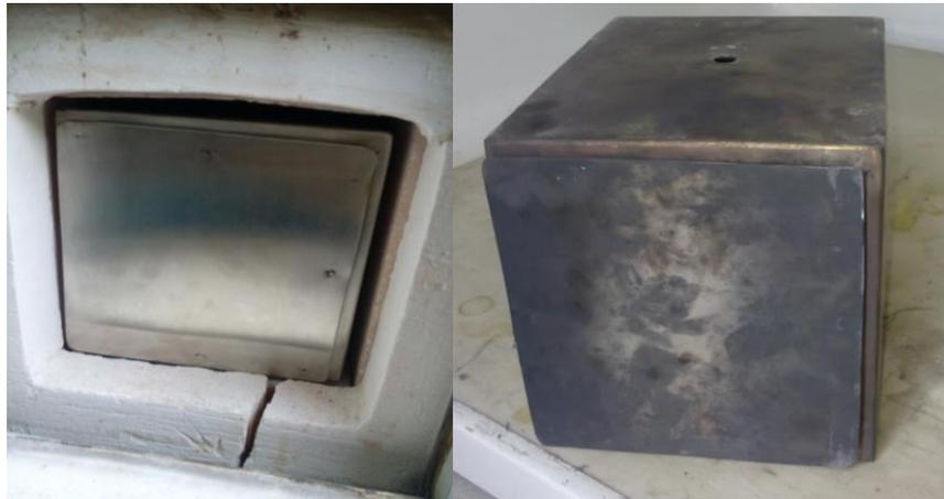
**Figura 3.3** Imagen de la caja de acero inoxidable empleada en la mufla modelo FE-361.
