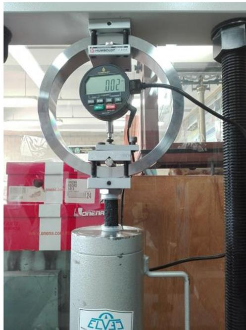
**Figura 5.2** Imagen del sistema empleado en la prueba de compresión.
