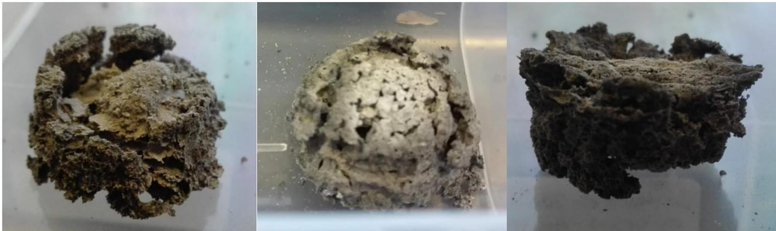
**Figura 4.10** Imagen de las muestras con secado en mufla (muestra 22), decantada (muestra 23) y en parrilla (muestra 24) **Tabla 4.13.**
