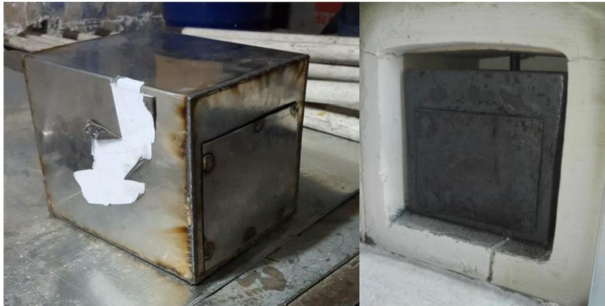
**Figura 3.4** Imagen de la caja de acero inoxidable empleada en la mufla modelo FE-360.
