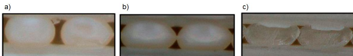
Figura 10. Espacio entre filamentos a) positivo ( > 0 [mm]), b) 0 [mm] y c) negativo ( < 0 [mm]) (adaptado de [79]).
