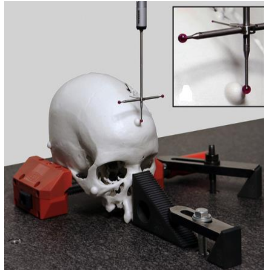
Figura 15. Caracterización por CMM de las dimensiones de un componente manufacturado por BJ (adaptado de [92])
