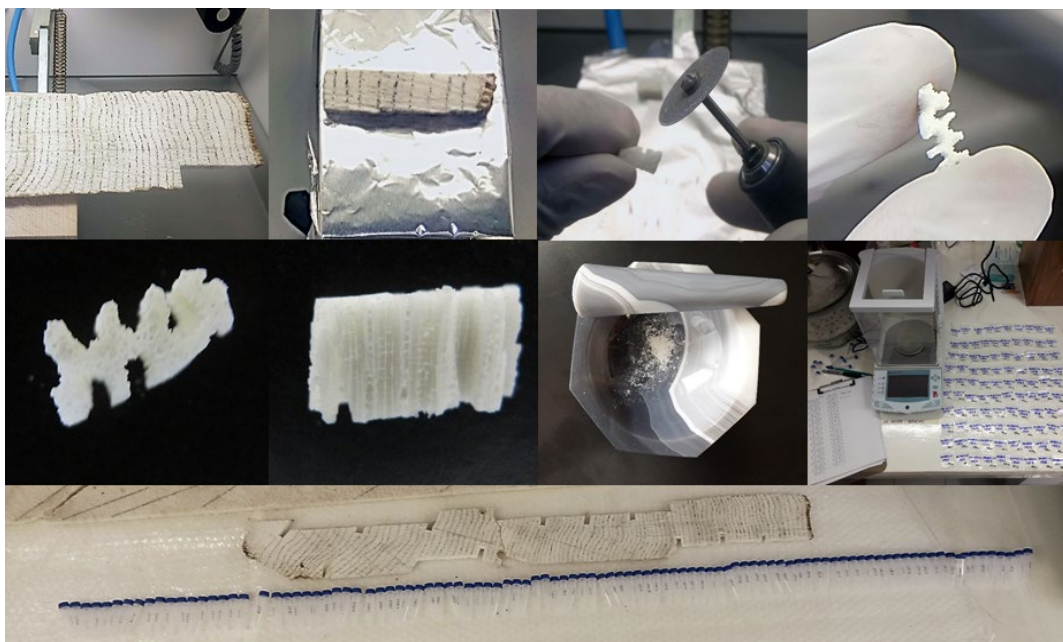
Figura 3.3. Corte, limpieza mecánica, molido y pesado de muestras de esqueleto de coral para análisis geoquímico.
