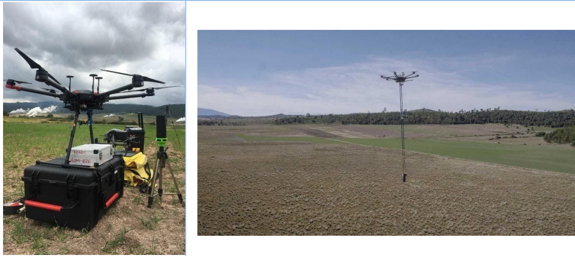
Figura 17.- Sistema aeromagnético de adquisición (SAMpD) utilizado para el levantamiento en la caldera de Los Humeros (izq.) en donde se observan los diferentes componentes. A la derecha de la figura se muestra el dron en vuelo con el magnetómetro suspendido verticalmente con sistema estabilizador multiaxial.
