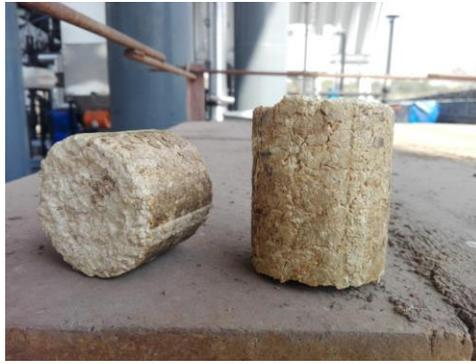
**Figura 4.3. Briquetas de la fracción fina del olote [6].**
