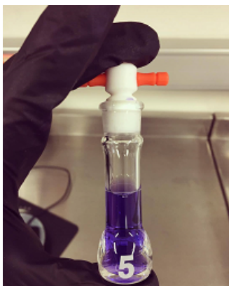
Figura 3.7: Última dilución de la muestra de púrpura de Ruhemann para ser analizadas en el espectrofotómetro
