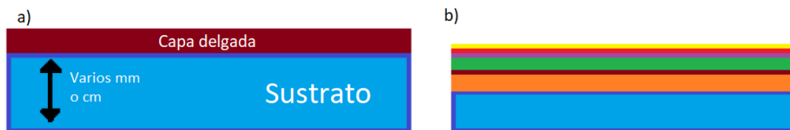
Figura 1.9: a) Esquema de una capa delgada recubriendo un sustrato y b) de un sistema multicapa físicoquímicas específicas y singulares, que guardan muy poca o ninguna relación con las propiedades iniciales del sustrato. Lo anterior, hace que éste se comporte como un mero soporte físico. Para este segundo tipo de aplicación se pueden ocupar capas sencillas o sistemas multicapas.(Figura 1.9 b)).
