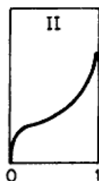
Figura 11: Isotermas de adsorción tipo II
