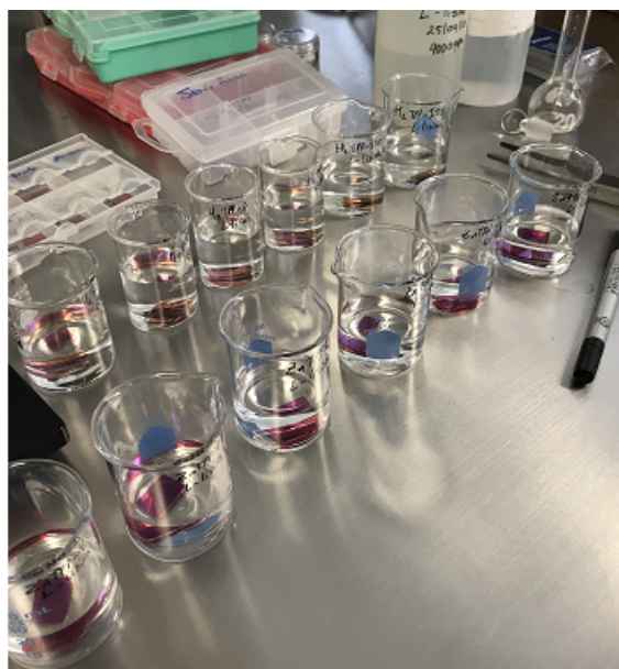
Figura 3.2: Películas de porfirina sumergidas en una disolución de aminoácido
