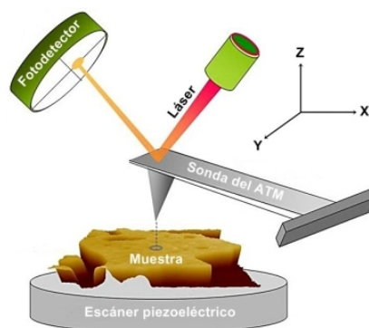
Figura 3: Esquema de funcionamiento de un microscopio de fuerza atómica [9]
