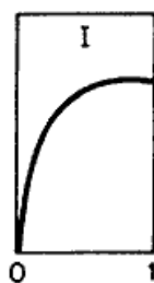
Figura 10: Isotermas de adsorción tipo I
