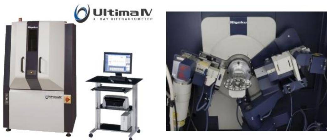
**Figura 26. Difractómetro Rigaku Ultima IV.**
