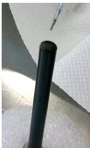
Figura 30. Deposición de tinta electroquímica sobre electrodo de trabajo.
