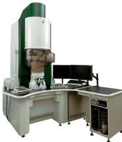
Figura 29. Microscopio electrónico TEM/STEM Jeol JEM--ARM200F.
