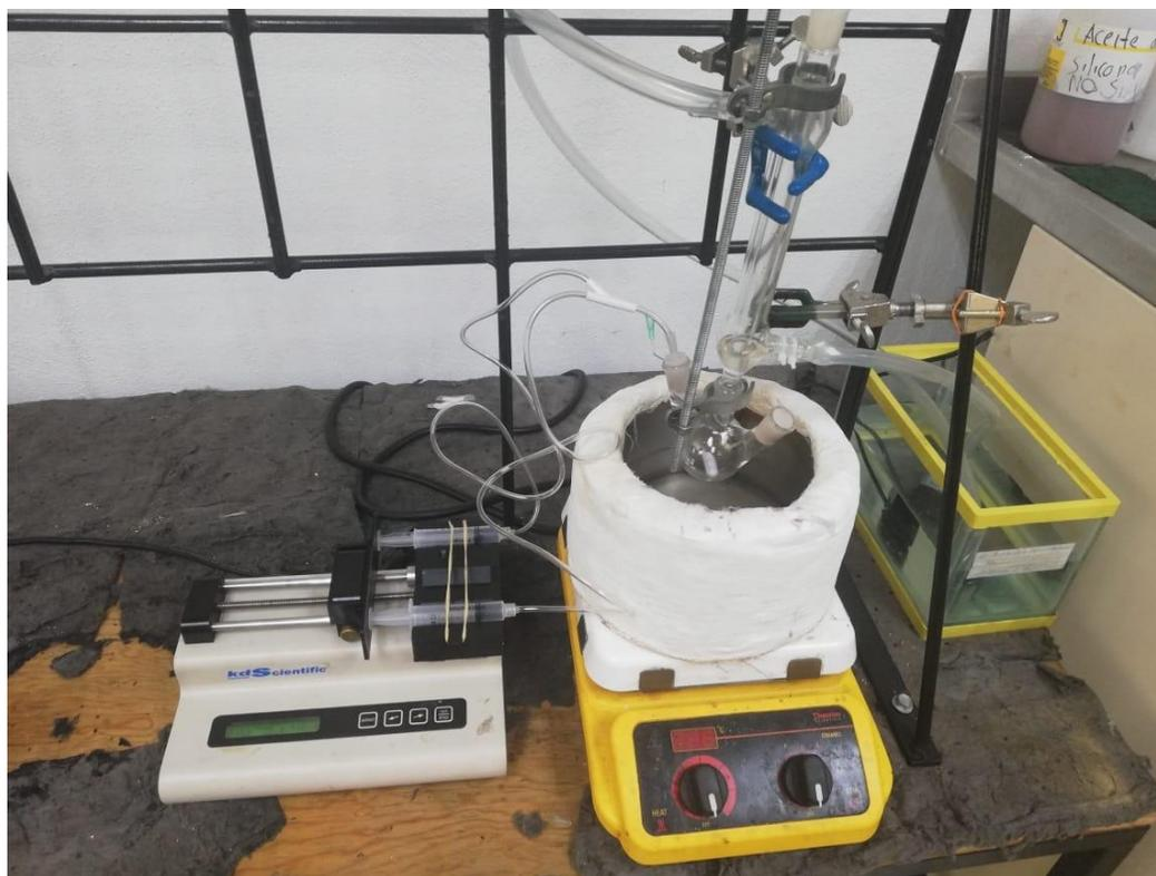
**Figura 21. Dispositivo para síntesis del polirol con control de temperatura**
