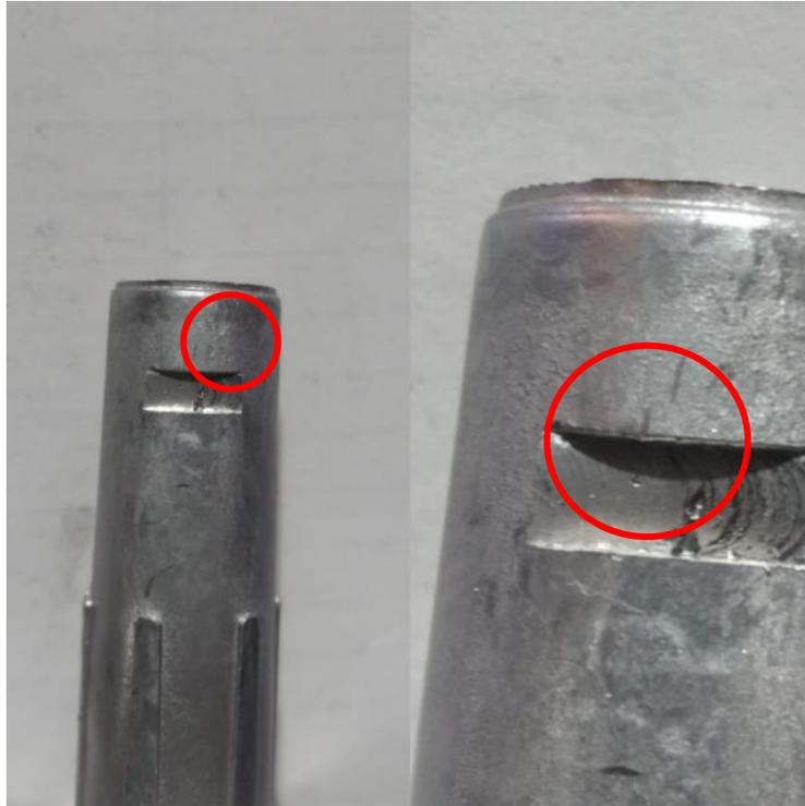
Figura 4.6 Pieza con poros. Fuente: Elaboración propia (2017).
