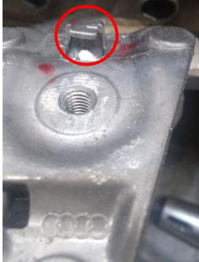
Figura 2.3 Ejemplo de una pieza chueca.
