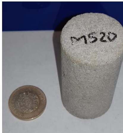
Figura 3.3 Núcleo de caliza utilizado en la evaluación de las PPG (elaborada por el autor).
